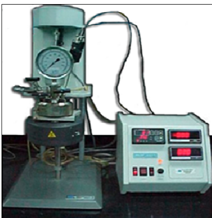
Figura 23. Equipo utilizado para efectuar los ensayos de polvo de hierro Para llevar a cabo la prueba se empleó polvo de hierro marca Riedel de Hägen cuya características más relevantes se presentan con detalle en la Tabla 16.
