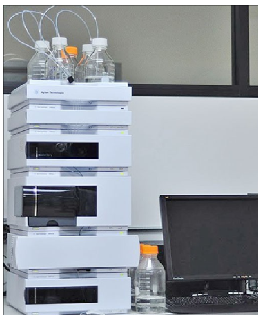
Figura 20. Cromatógrafo Líquido Marca Agilent Technologies, modelo HPLC 1200, con detección RI, utilizado en el análisis CET
