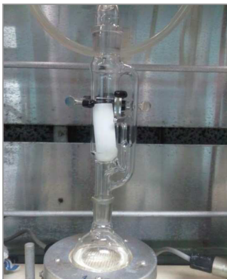
Figura 13. Extractor Soxhlet empleado en la extracción de ácidos orgánicos en crudo
