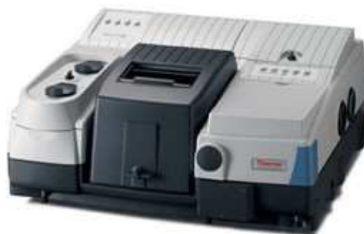
Figura 18. Equipo FTIR Thermo Nicolet 6700
