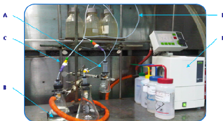
Figura 14. Equipo de extracción en fase sólida. A) cartucho de polipropileno. B) Kitasato. C) Conector PTFE. D) Tuberías de teflón. E) Bomba de succión
