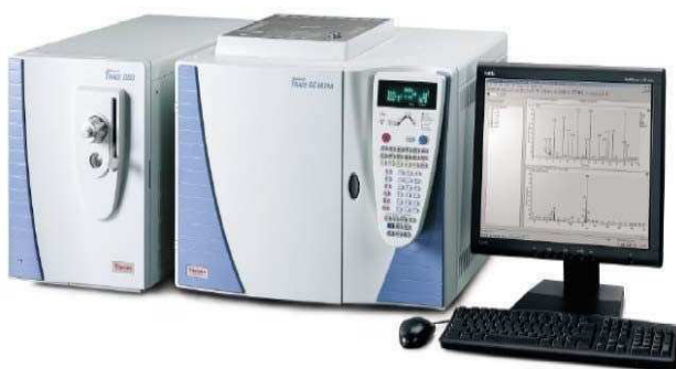
Figura 19. Cromatógrafo de gases marca Thermo, modelo Trace Ultra acoplado a un espectrómetro de masas. Modelo DSQ II
