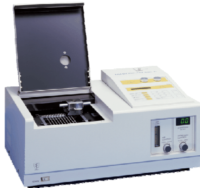
Figura 22. Equipo latroscan modelo MK-6 TLC-FID para determinación del fraccionamiento SARA
