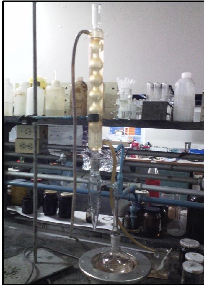
Figura 3.1. Montaje de destilación para la prueba de deshidratación por destilación.
