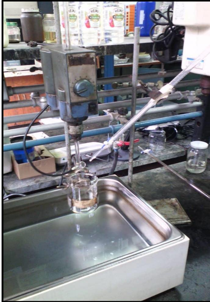
Figura 3.2. Montaje para la preparación de emulsiones agua/crudo.
