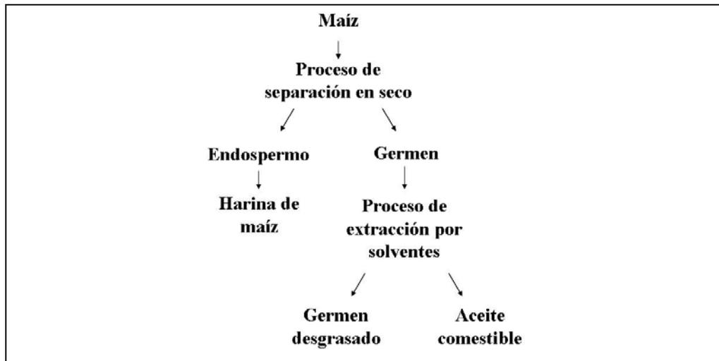
**Figura. 2.6** Esquema del proceso de obtención del germen desgrasado de maíz <sup>[31]</sup>
