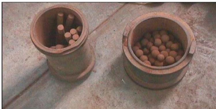
**Figura 3.2** Molino de barras y molino de bolas con sus respectivos cuerpos moledores.
