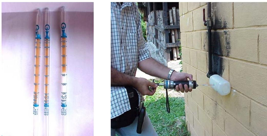
**Figura N°5.7:** Determinación de sulfuro de hidrógeno ( $H_2S$ )
