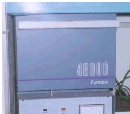
FIGURA 26. Mufla de calcinación de los diversos catalizadores sólidos ácidos.
