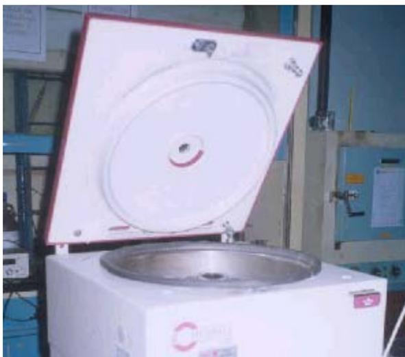
**FIGURA 35.** Centrifuga de separación eficiente.
