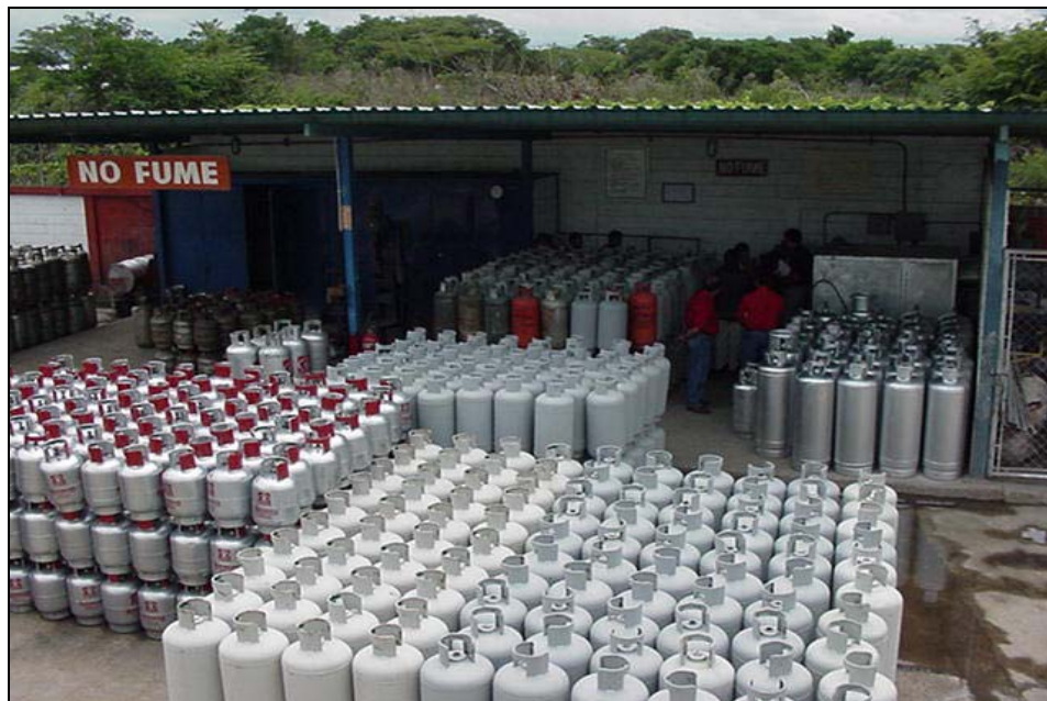
Foto N° 16 Pintura y valvulado de cilindros para el llenado
