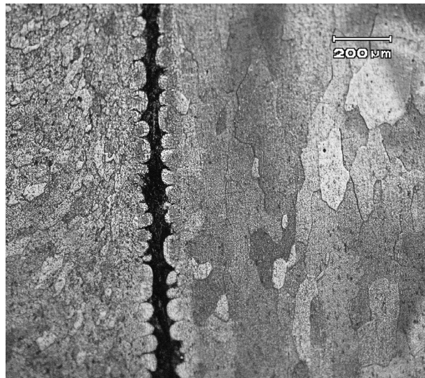
Figura 4.18 Micrografía Unión tapa-tubo distribuidor Muestra 2. Aumento 100X
