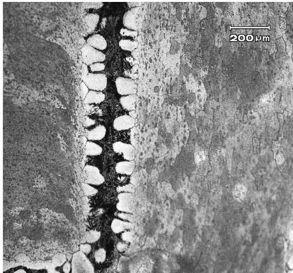
Figura 4.19 Micrografía Unión divisor-tubo distribuidor Muestra 1. Aumento 100X
