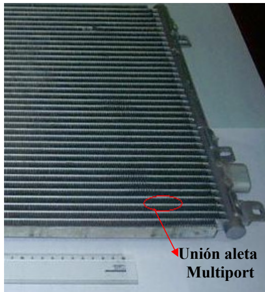
Figura 3.12 Vista frontal de Colmena Condensador
