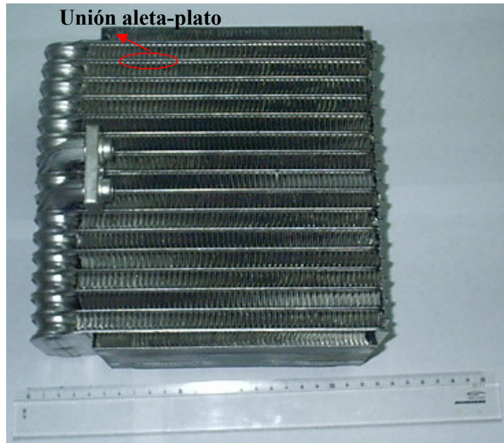
Figura 3.9 Vista Frontal Colmena Evaporador
