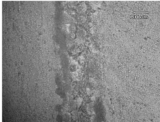
Figura 4.32 Micrografía Unión divisor-tubo distribuidor. Aumento 200X
