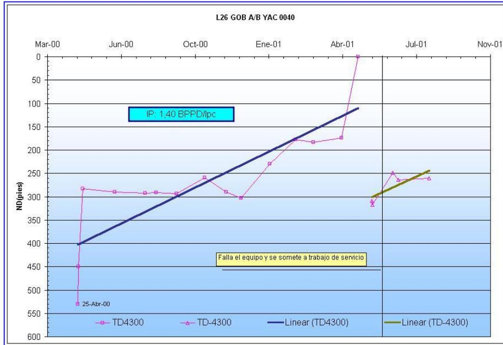
Figura 17: Comportamiento del ND para el pozo L26
