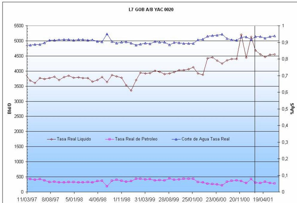
Figura 57: Comportamiento de producción para el pozo L7
