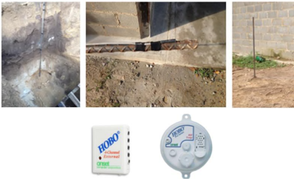
Figura 2. Proceso de excavación y colocación de los sensores para el registro de la temperatura del suelo. Fuente: Elaboración propia.
