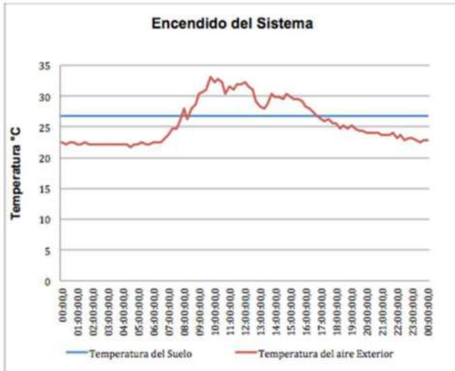
Figura 7. Temperaturas registradas durante la experimentación dentro y fuera del tubo Fuente: Elaboración propia.
