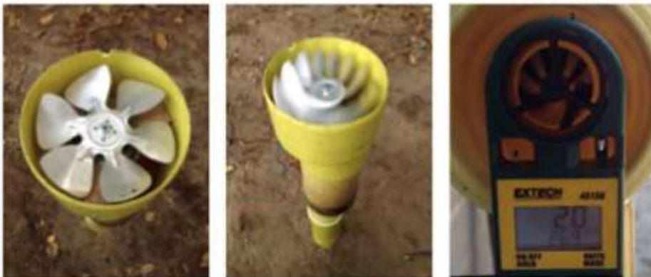
Figura 5. Instalación del ventilador y medición del aire dentro del tubo. Fuente: Elaboración propia.
