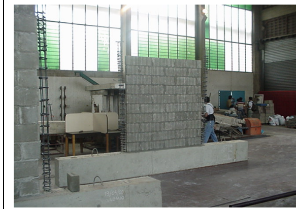
MURO TIPO "B" MAMPOSTERIA CONFINADA OMNIBLOCK APAREJO 1/2
