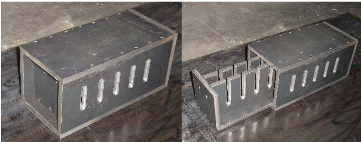
Figura 6.20. Ensamblaje final del disipador.
