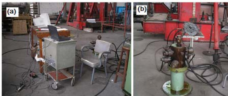
Figura 6.40. Componentes del equipo de ensayo: (a) Sistema de control y alimentación de los actuadores, (b) Sistema de realimentación.
