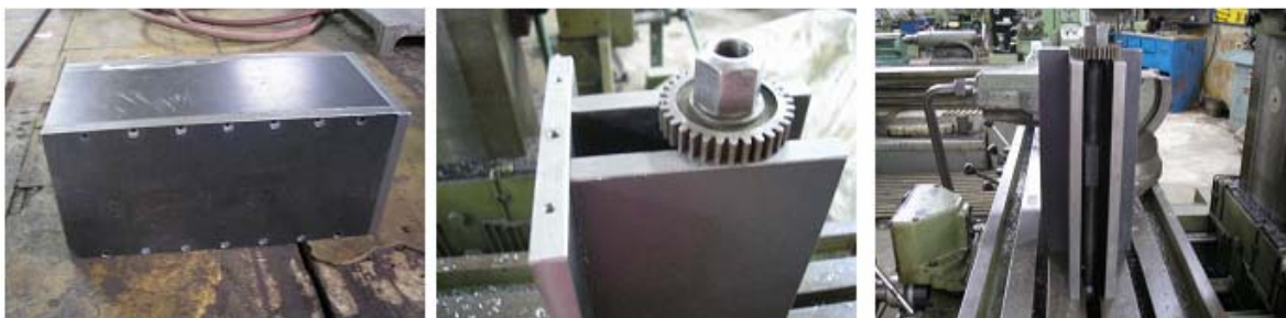
Figura 6.18. Apertura de orificios, colocación de tornillos, ajuste y ensamblaje.
