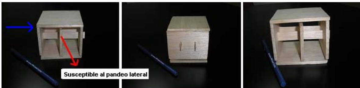
Figura 6.5. Prototipo del modelo 3. Vista frontal. Vista lateral y Perspectiva. Modelo construido en madera balsa, escala 1:3.
