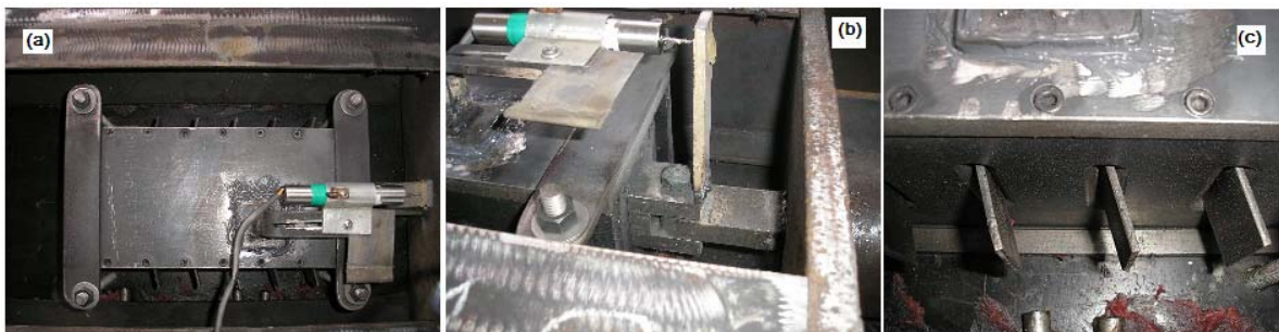
Figura 6.46. Ejecución del ensayo: (a) Vista superior flexión hacia la izquierda en las láminas, (b) Detalle del desplazamiento de la pieza interna del disipador, (c) Detalle de la deformación experimentada por las láminas.
