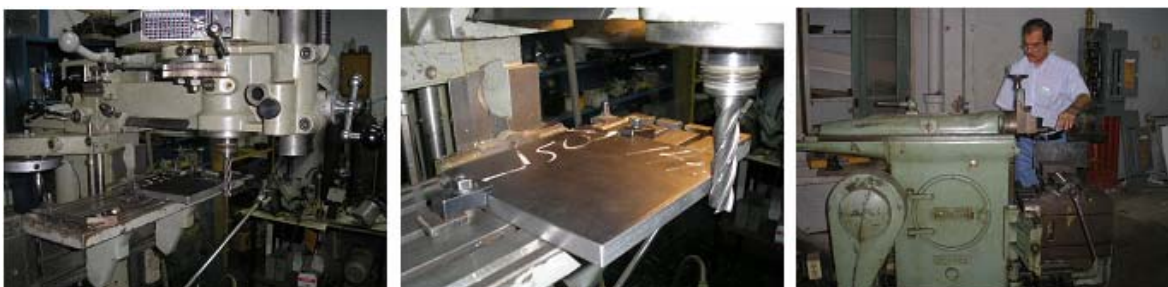
Figura 6.16. Ajuste a las dimensiones de diseño por fresado de las láminas.
