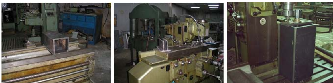
Figura 6.17. Presentación y ajuste de cada una de las láminas componentes.
