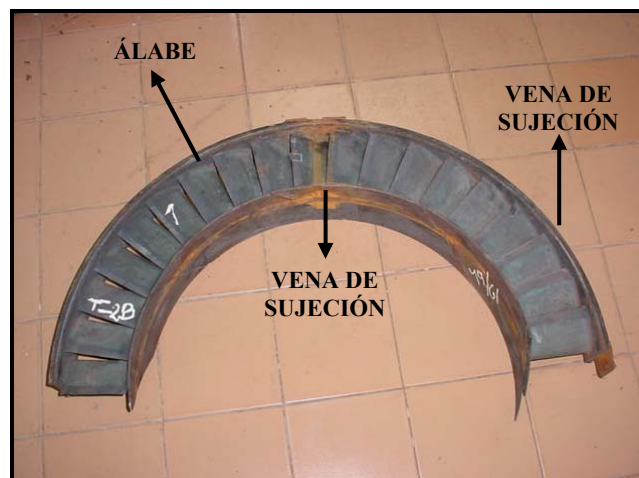
Figura 20: Anillo semicircular de la tobera de 1era etapa de la turbina a gas en estudio
