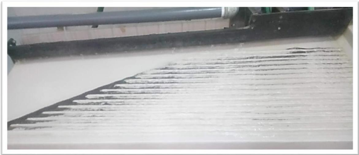
Figura N° 17 Distribución de material por separación gravimétrica
