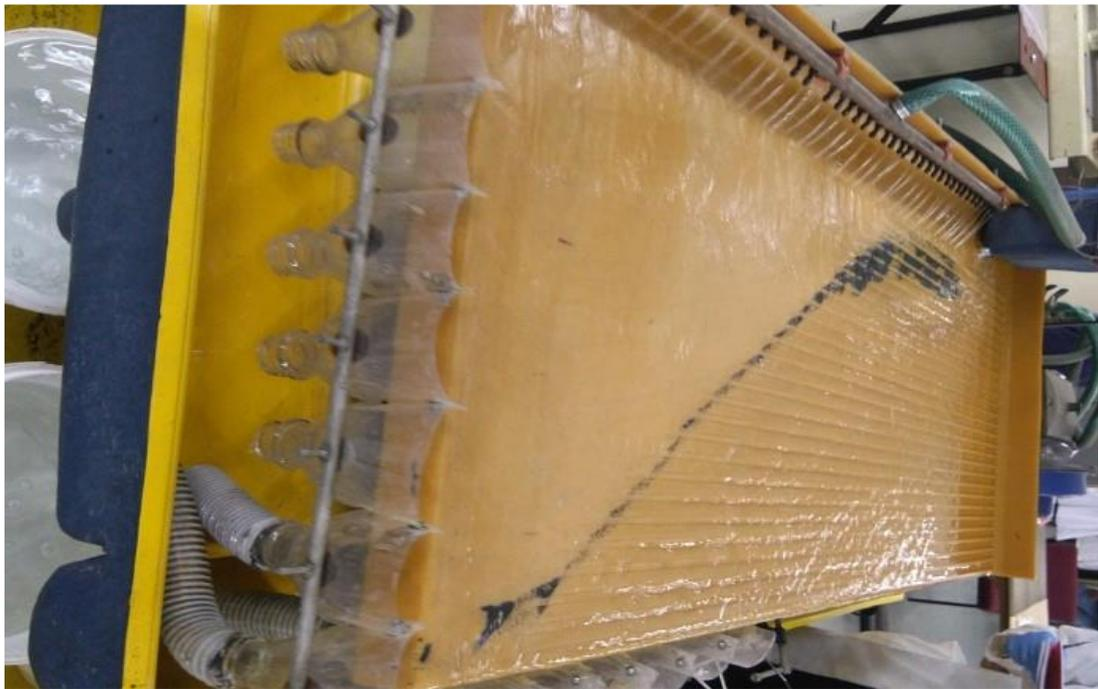
Figura N° 14 Esquema de separación de ilmenita por método gravimétrico
