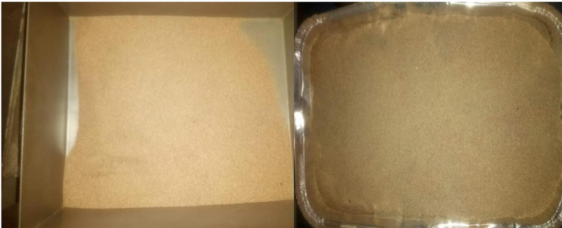
Figura N° 22 Material estéril tras separación magnética
