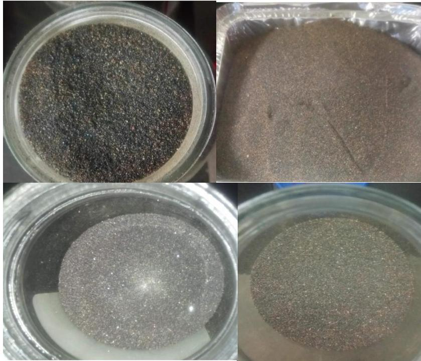
Figura N° 23 Concentrados de separación magnética
