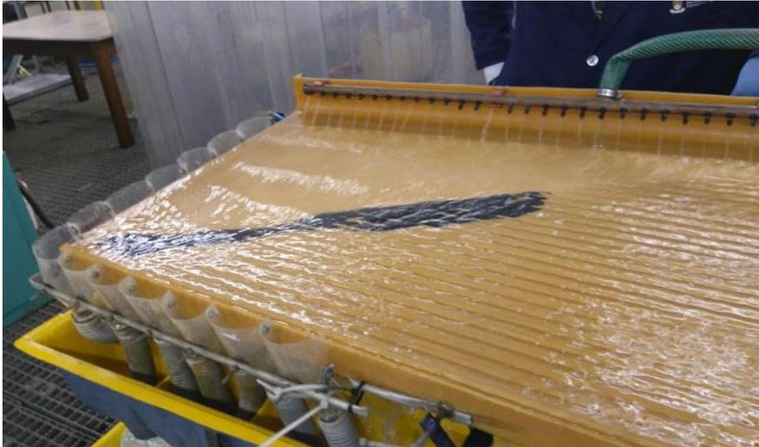
Figura N° 13 Esquema de separación de Ilmenita por método gravimétrico
