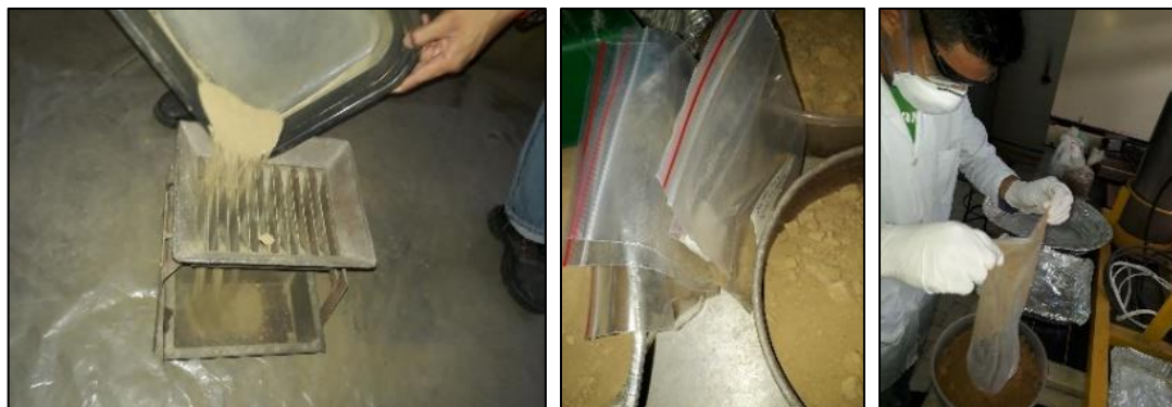
Figura 18. Homogenización, cuarteo e identificación de las muestras. Fuente: Elaboración propia.
