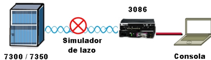
Figura A.1. Montaje para pruebas de distancias y potencias del PATTON 3086FR.
