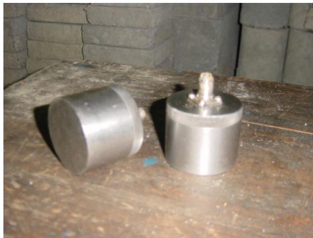
Figura N°24 Transductores de 54 KHz..
