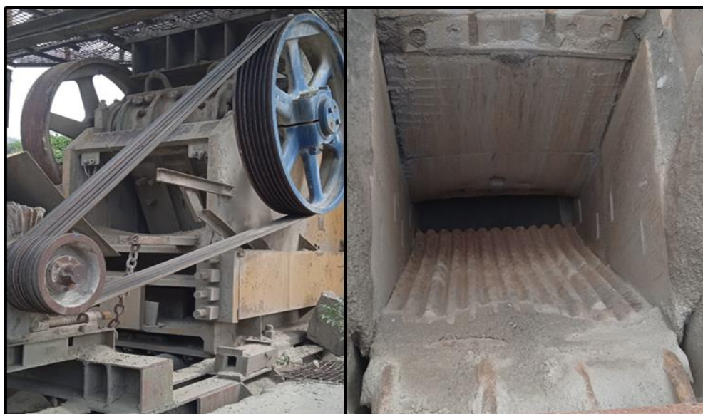
Figura 47. Trituradora de mandíbula Loro & Parisini Modelo Margutt 1250 CR
