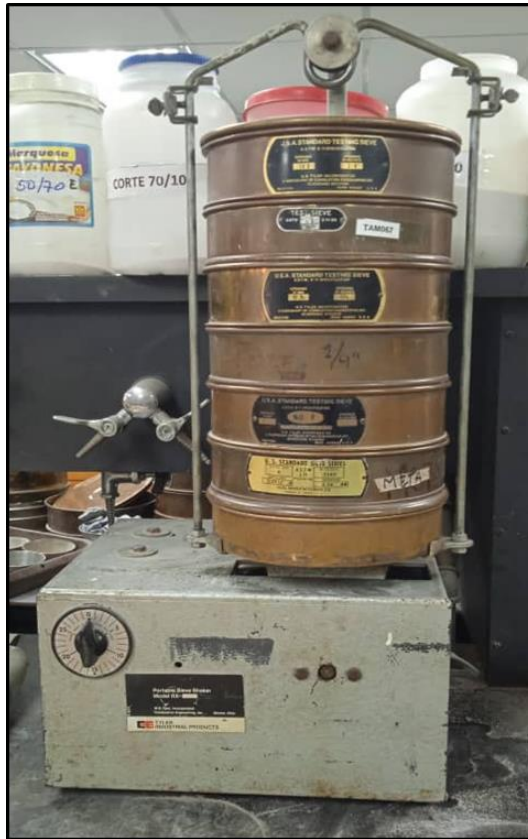
Figura 32. Mesa de tamizado Fuente: Laboratorio de Mecánica de Rocas “Miguel Castillejo”
