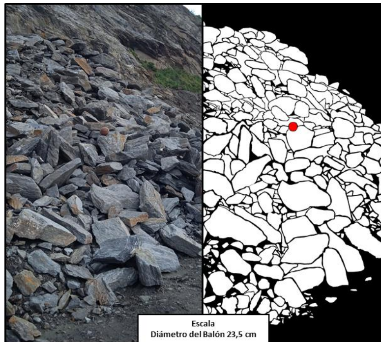
Figura 52. Análisis fotográfico de distribución de tamaños de todo uno
