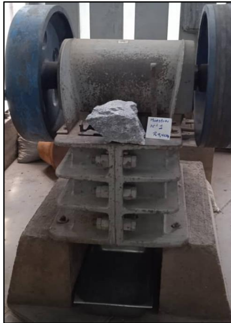
Figura 41. Trituradora de mandíbula de la marca Denver Co. F. Laboratorio de Beneficio de Mineral
