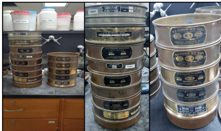
Figura 31. Batería de tamices. Fuente: Laboratorio de Mecánica de Rocas “Miguel Castillejo”
