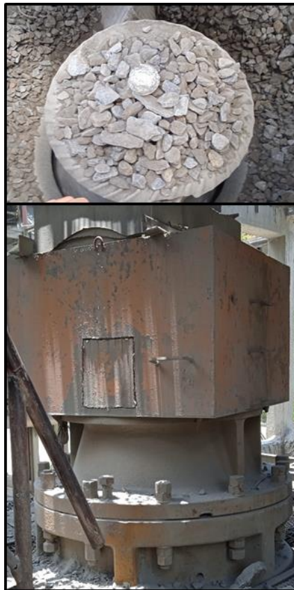
Figura 49. Trituradora de cono Loro & Parisini modelo 10-51 Allis Chalmers
