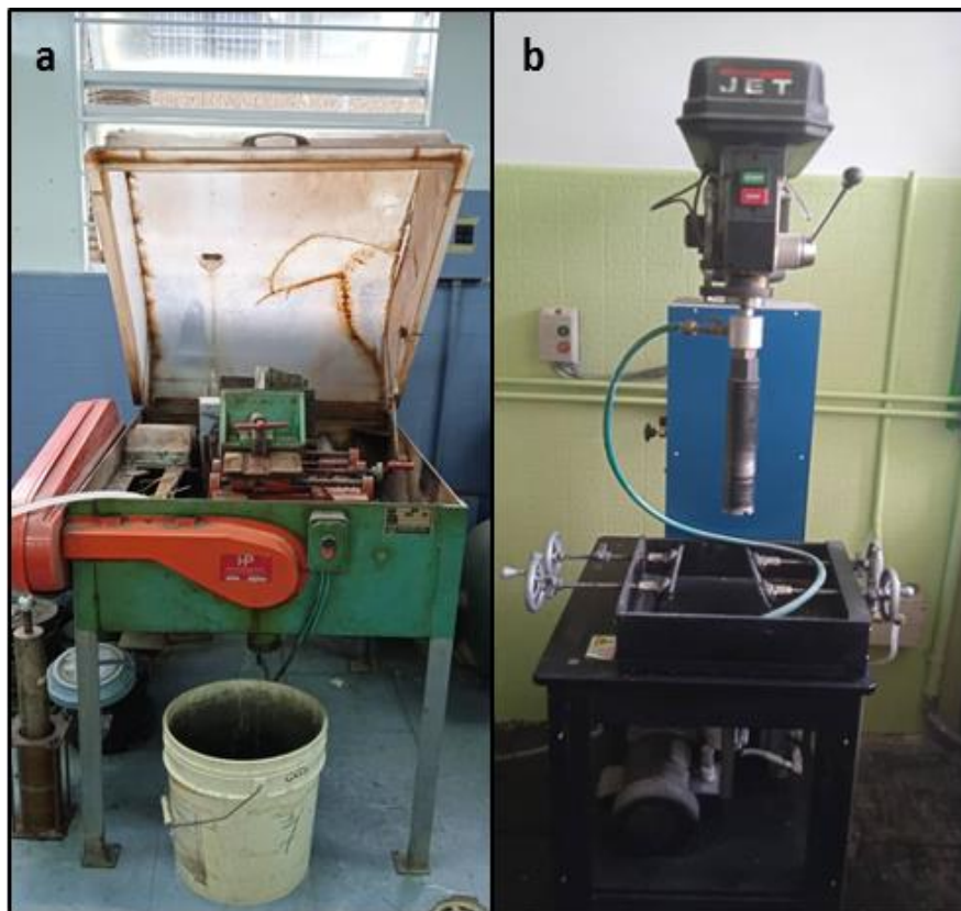
Figura 35. a) Máquina de disco de corte y b) Máquina de extracción de núcleo. Fuente: Laboratorio de Mecánica de Rocas, U.C.V.
