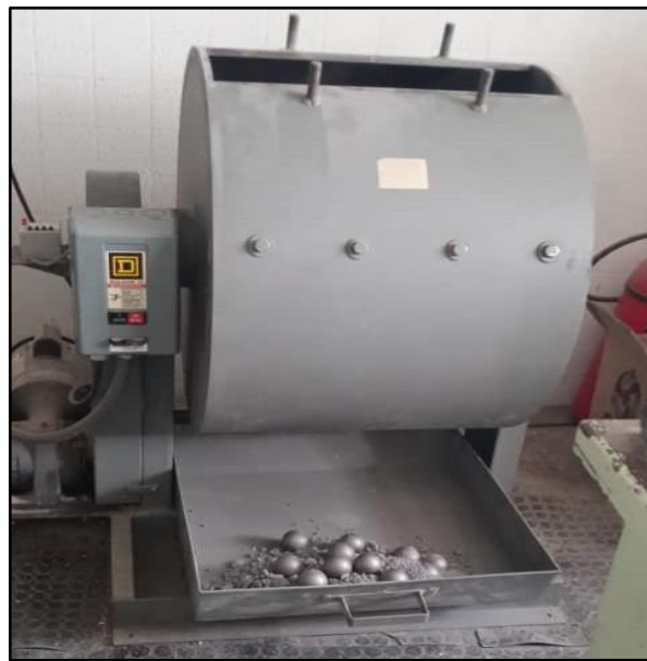
Figura 39. Máquina de los Ángeles. Fuente: Laboratorio de Mecánica de Rocas, U.C.V.
