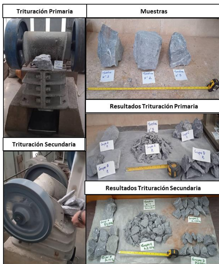
Figura 64. Ensayo de fragmentación para determinar forma
