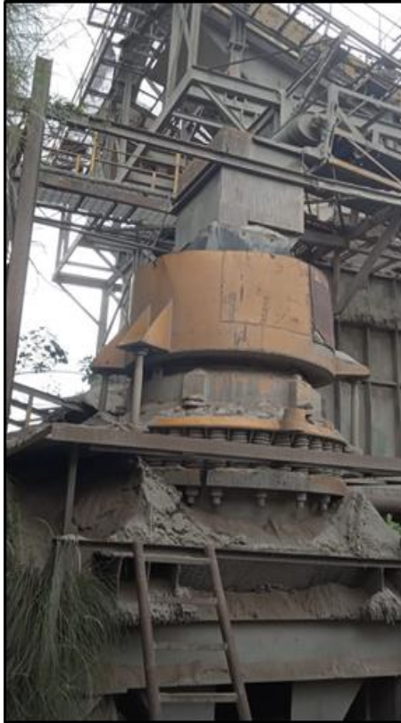
Figura 50. Trituradora de cono Loro & Parisini modelo 10-51 Allis Chalmers
