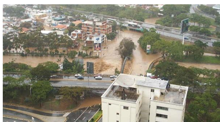
Figura 21. Inicio de la inundación del río Guaire en la California Sur en febrero 2005, causado por la contracción vertical que ejerce el puente. Observe la gran turbulencia del flujo al chocar con las vigas del tablero del puente (Fotos extraídas de Internet).
