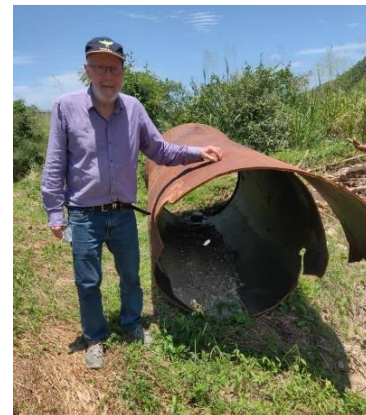
Figura 24. Restos de los tubos depositados aguas abajo en el lecho de la canalización del río Camurí Grande. El diámetro de los tubos es de 1,10 m (Foto tomada el 12/09/21).
