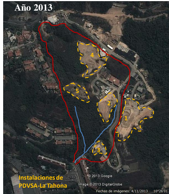
Figura 8. Vista satelital de la cuenca tributaria del pequeño afluente de la quebrada La Boyera, mostrando la situación para el año 2004 (izquierda) y para el año 2013 (derecha). En la imagen del 2013 se aprecian claramente los movimientos de tierra efectuados que causaron una sobrecarga de sedimentos durante las crecientes. Las líneas a trazos en color amarillo delimitan cinco (5) zonas donde se observan suelos desnudos por remoción de vegetación (Imágenes de Google Earth).
