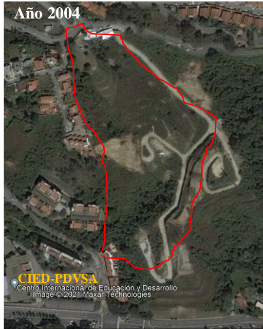
Figura 8. Vista satelital de la cuenca tributaria del pequeño afluente de la quebrada La Boyera, mostrando la situación para el año 2004 (izquierda) y para el año 2013 (derecha). En la imagen del 2013 se aprecian claramente los movimientos de tierra efectuados que causaron una sobrecarga de sedimentos durante las crecientes. Las líneas a trazos en color amarillo delimitan cinco (5) zonas donde se observan suelos desnudos por remoción de vegetación (Imágenes de Google Earth).
