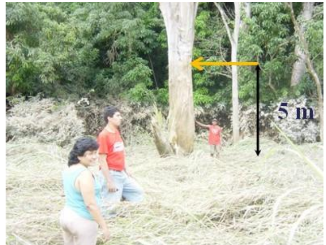
Figura 13. Izquierda: vista de la alcantarilla obstruida por restos vegetales y sedimentos, cuya profundidad de sedimentación era de aproximadamente 5 m sobre el tope del conducto. Derecha: marca sobre un árbol de la altura que alcanzaron las aguas (5 m sobre el nivel del terreno), en la laguna que se creó debido a la obstrucción.
