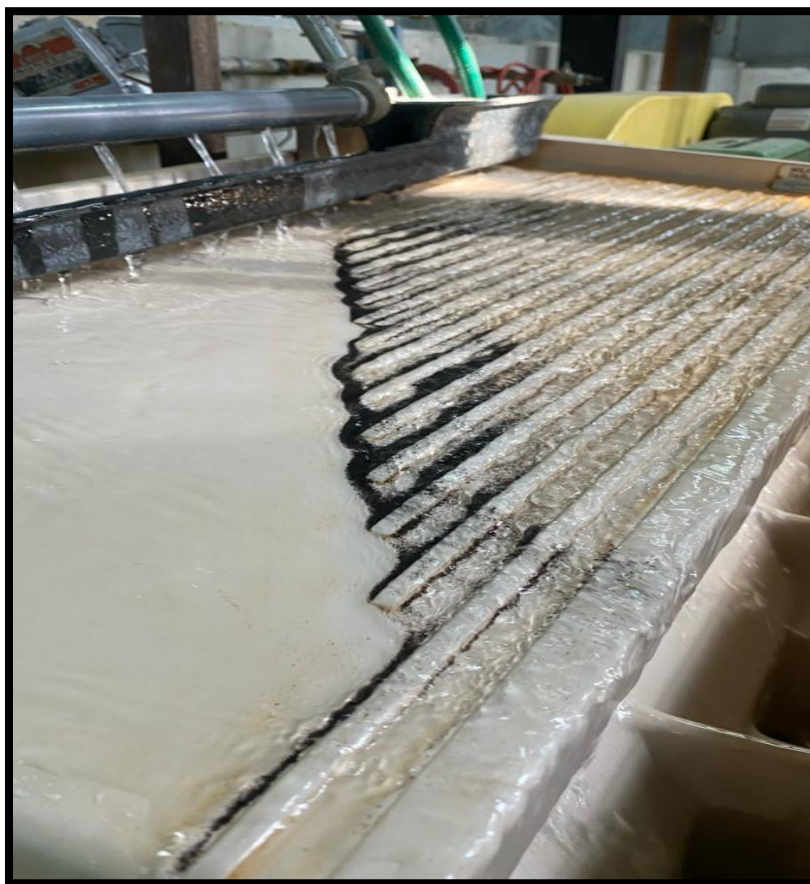
Figura 38. Separación gravimétrica en la mesa vibratoria Wilfley, Fase II, 6 grados de inclinación
