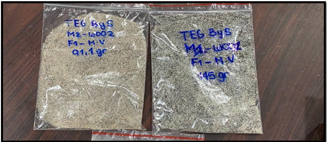
Figura 37. Concentrado secado M1-W001 y M2-W002, de la mesa vibratoria Wilfley, Fase I. Tomando en cuenta todas las consideraciones anteriores, se realizó una segunda corrida, para conocer la tendencia de las partículas pesadas en el lecho fluidizado de la mesa, si se aproxima al estudio exploratorio de 8 grados de inclinación o si, por el contrario, marca
