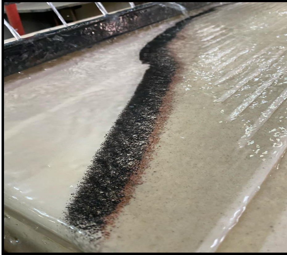
Figura 36. Separación gravimétrica en la mesa vibratoria Wilfley, Fase I, 4 grados de inclinación.
