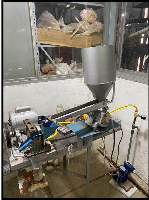
Figura 16. Fotografía de una Criba hidráulica Marca Denver (JIG) del laboratorio de Termocronología del Departamento de Geología- UCV. Fuente: Elaboración propia.
