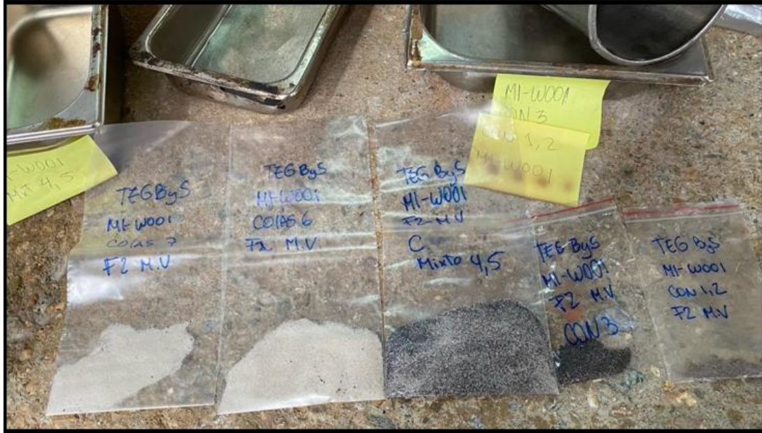
Figura 39. Productos: Concentrado, Mixto y Colas de M1-W001 y M2-W002 en la mesa vibratoria Wilfley, Fase II, 6 grados de inclinación
