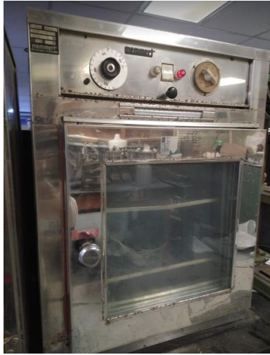
Figura N° 30: Horno utilizado en laboratorio para secar las muestras luego de cada ciclo de Slake Durability.
