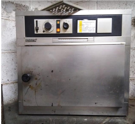
Figura N°41: Horno para el secado de la muestra de densidad de suelo aparente. Fuente: Elaboración Propia.
