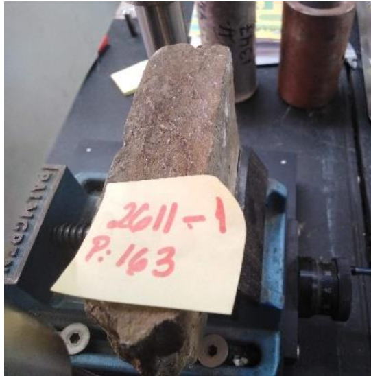
Figura N°38: Colocación de la muestra en la cara con más foliaciones.
