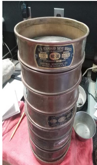
Figura N°34: Batería de tamices para realizar granulometría de los sedimentos. Fuente: Elaboración Propia.
