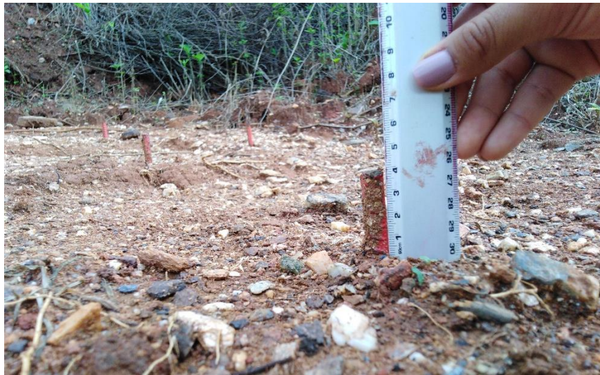
Figura N°46: Medición de los clavos de las parcelas de erosión.
