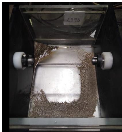
Figura N° 31: Muestra originada por el ensayo Slake Durability, después de su primer y segundo ciclo.
