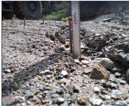
Figura N°26: Medición de Parcela #3 de erosión. Fuente: Elaboración Propia.
