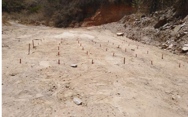
Figura N°25: Instalación de Parcela #3 de Erosión por Clavos previamente instalada. Fuente: Elaboración Propia.
