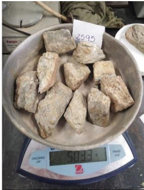
Figura N°29: Muestra pesada antes de ser sometida al primer ciclo del Ensayo de Slake Durability Elaboración: Elaboración Propia.
