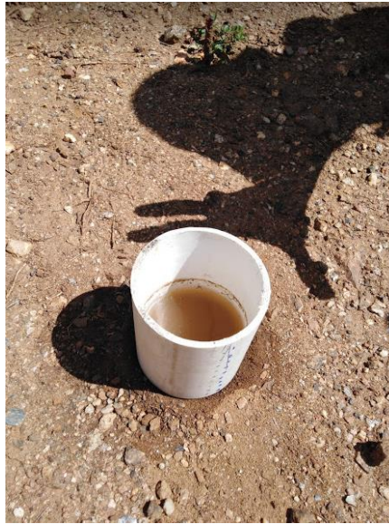
Figura N°43: Ensayo para medir la infiltración de los suelos.
