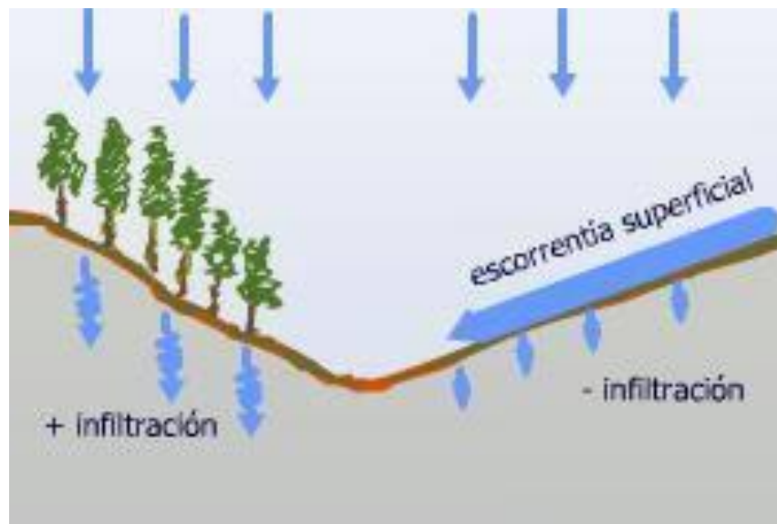
Figura N°16: Infiltración del Suelo.
