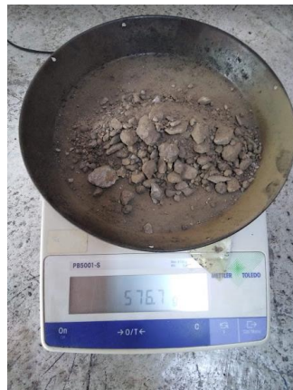
Figura N°42: Peso de la muestra de suelo aparente. Fuente: Elaboración Propia.
