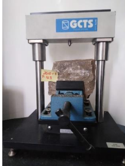
Figura N°36: Muestra colocada para iniciar el ensayo de Cerchar. Fuente: Elaboración Propia.
