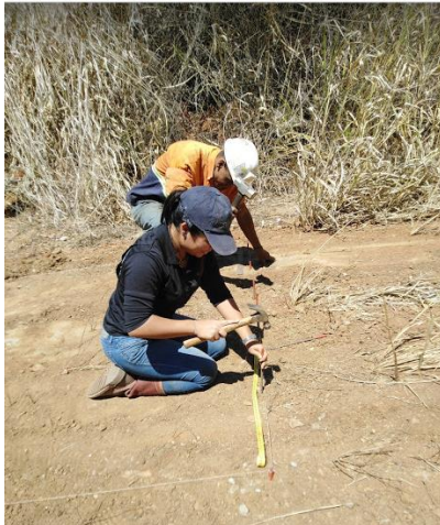
Figura N°47: Instalación de las Parcelas de Erosión con Clavos.
