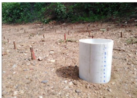
Figura N°40: Cilindro PVC, para toma de muestra y capacidad de infiltración.
