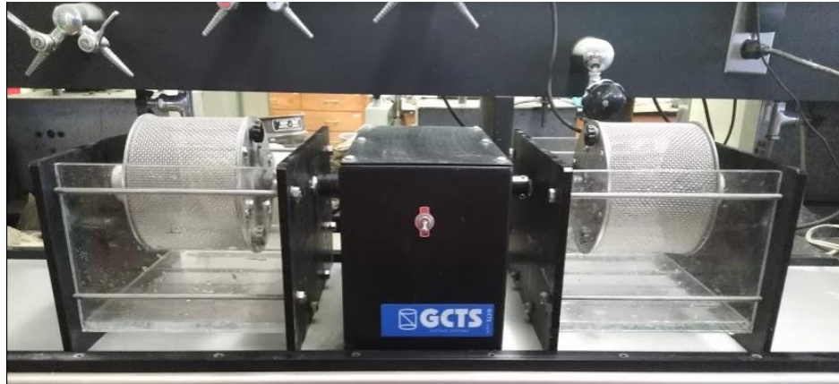
Figura N° 28: Equipo de Slake Durability (sin muestra). Fuente: Elaboración Propia.
