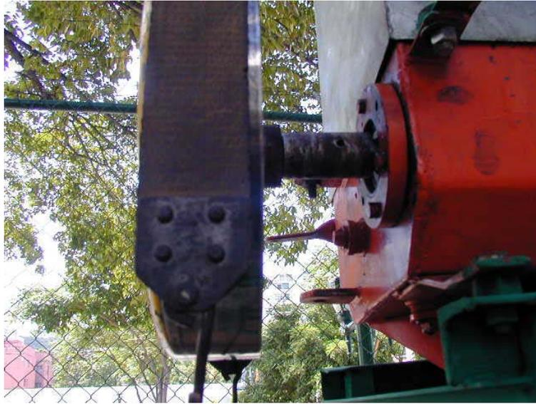
Foto 17. Vista de la forma de acople del conjunto tambor-eje-tubo con el eje del molino.
