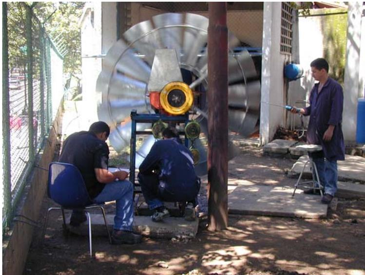
Foto.20 .Momento en el que se le esta aplicando carga al dinamómetro y tomando las mediciones de la velocidad del viento
