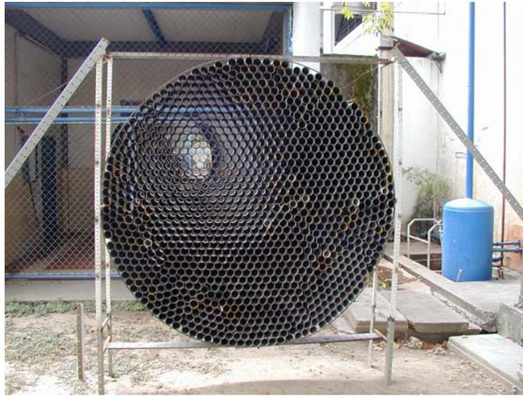
Foto 23. Vista posterior del enderezador de flujo.
