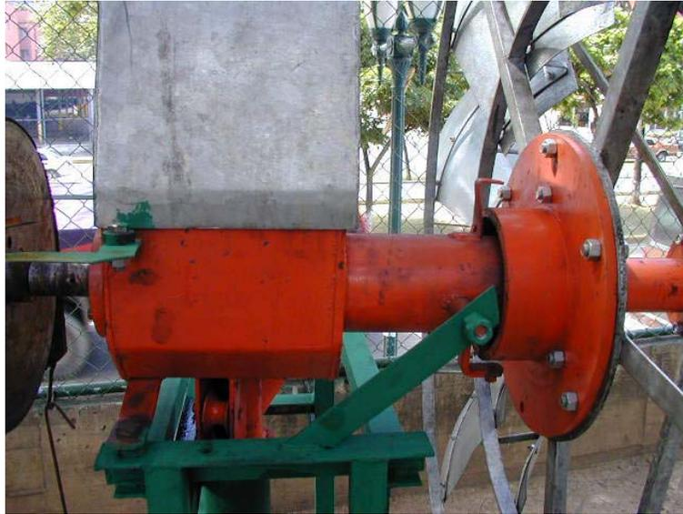
Foto 19. Sujeción del molino a la base.
