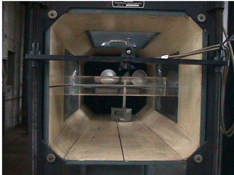
Foto 5. Ubicación del anemómetro dentro del túnel de viento subsonico.
