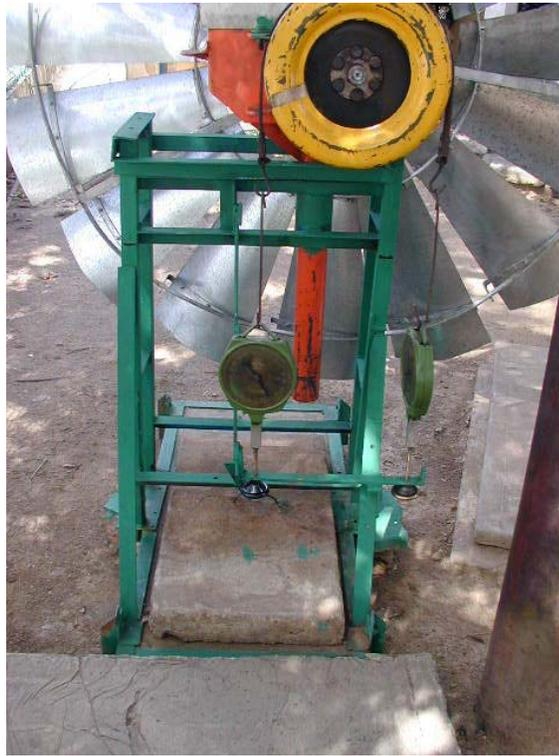
Foto 16. Vista posterior del la base con el tambor y las dos balanzas del freno Prony.
