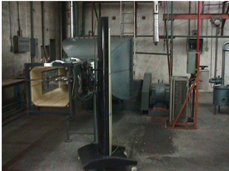
Foto 4. Vista del túnel de viento subsónico que se encuentra en el galpón de laboratorios de la Escuela
