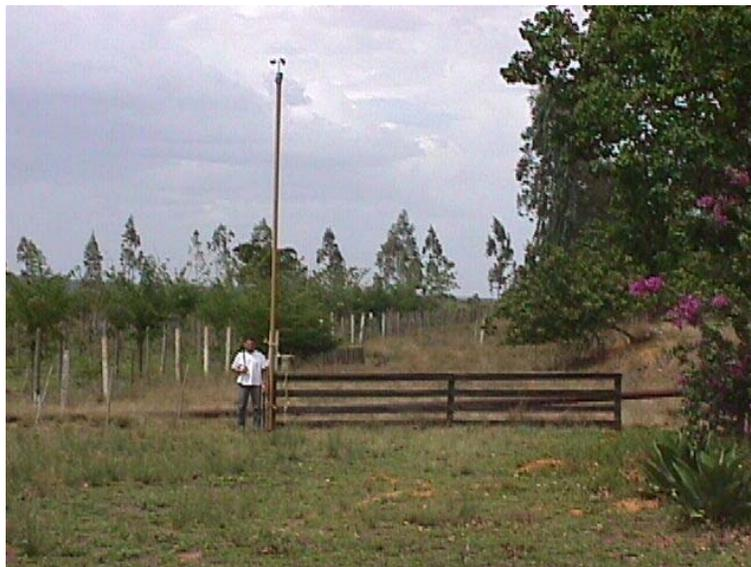
Foto 8. Proporcionalidad entre el tamaño de la persona y la altura del soporte de anemómetro de copas.
