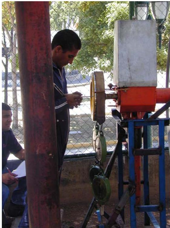
Fotos 21. Medición de las rpm del eje del aeromotor con el tacómetro mecánico.
