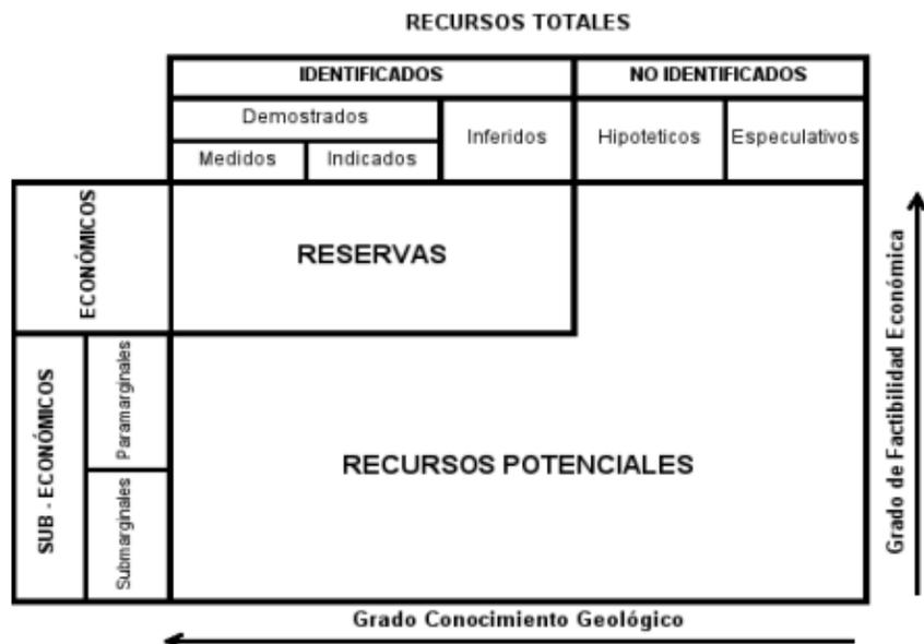
**Figura 8. Clasificación de recursos por el U.S. Bureau of mines y el U.S. Geological Survey. Tomado de Plata 2013.**
