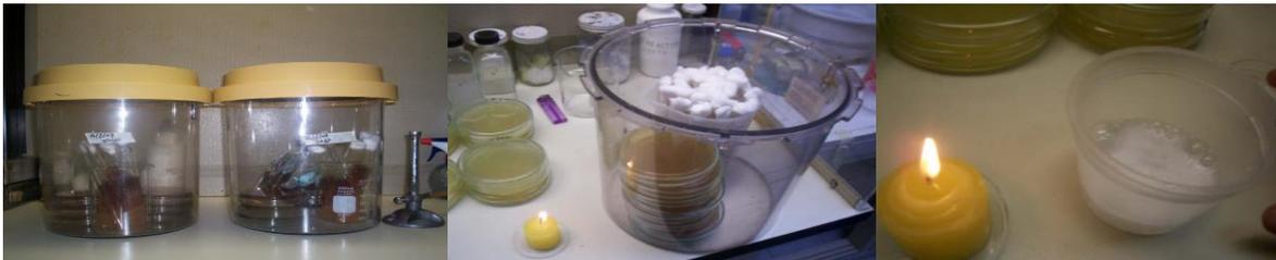
**Figura 13:** Jarras Gas Pack y materiales utilizados para la incubación anaeróbica en la investigación de bifidobacterias en productos lácteos tipo yogurt
