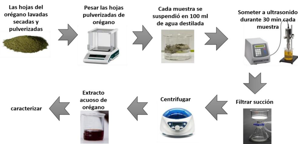
**Figura 44. Esquema para la preparación del extracto acuoso de orégano (propio)**
