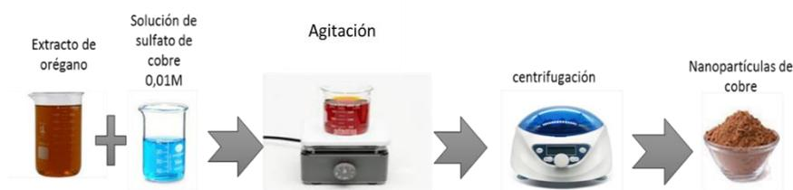
**Figura 45. Esquema para la preparación de las nanopartículas de cobre a partir de extracto acuoso de orégano (propio)**
