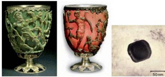
**Figura 1. Color cambiante de la copa de Licurgo (verde con luz reflejada y rojo con luz transmitida) y una de las nanopartículas de oro que contiene el vidrio. [3]**
