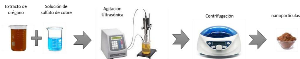
**Figura 46.** Esquema para la preparación de las nanopartículas de cobre a partir de extracto acuoso de orégano vía ultrasonónica (propio)
