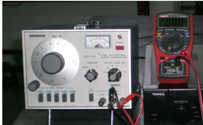
Figura 4.21 Conexión del generador de señales con el multímetro. Fuente: el autor
