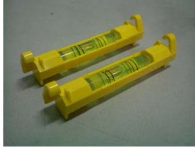
Figura 4.5 Niveles de línea. Fuente: el autor
