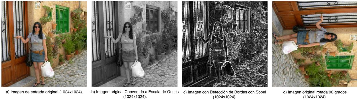
Figura 6.3: Imágenes resultantes del procesamiento digital usando el esqueleto **TaskSkeleton**: a) Imagen original a color RGB (formato .jpg), b) Imagen convertida a escala de 256 grises, c) Imagen con bordes de objetos resaltados (con máscara Sobel), y d) Imagen con Rotación. Fuente: Elaborado por el autor.
