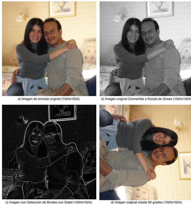
Figura 4.15: Imágenes resultantes del procesamiento digital: a) Imagen original a color RGB (formato .jpg), b) Imagen convertida de color a escala de 256 grises, c) Imagen con bordes de objetos resaltados (con máscara Sobel), y d) Imagen con Interpolación. Fuente: Elaborado por el autor.
