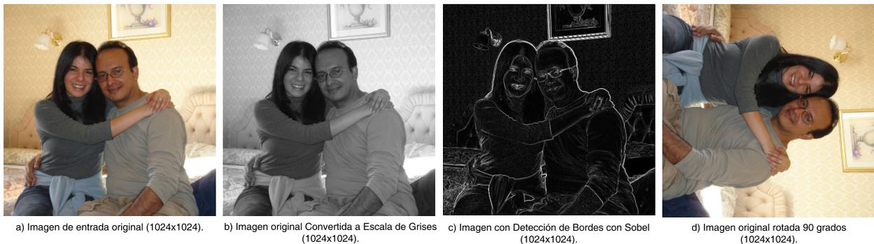
Figura 4.17: Imágenes resultantes del procesamiento usando el esqueleto **SEQSkeleton**: a) Imagen original a color RGB (formato .jpg), b) Imagen convertida de color a escala de 256 grises, c) Imagen con bordes de objetos resaltados (con máscara Sobel), y d) Imagen con Rotación. Fuente: Elaborado por el autor.
