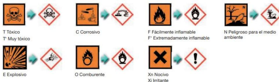
*Fig. 5.14.* Símbolos gráficos normalizados que avisan de peligros concretos en los materiales almacenados. Los antiguos pictogramas coexisten con los nuevos, dependiendo del tipo de producto, hasta 2012 en unos casos y hasta 2017 en otros.
