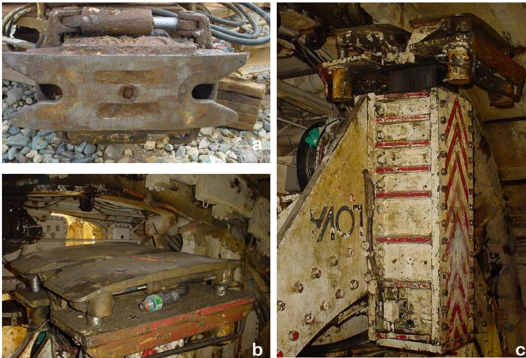
Figura 108. Cabeza del erector en la tuneladora empleada en: a) tramo El Valle-Coche del Metro de Caracas y b, c) Metro de Valencia.
