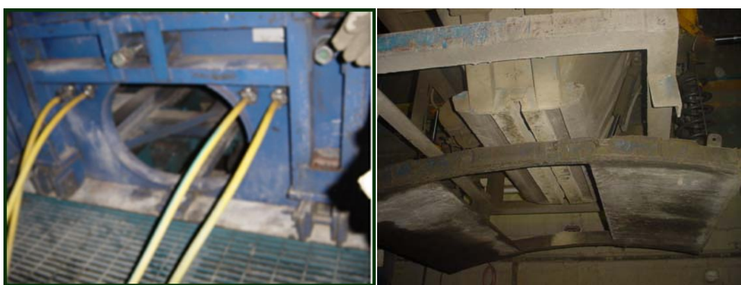
Figura 96. Izquierda: Mangueras del sistema de vibrado.. Derecha: Tolva de vaciado y placa (Fuente: Cavalli).
