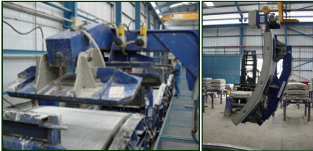
Figura 99. Sistema de vacío para desmolde de segmentos (Fuente: Cavalli).
