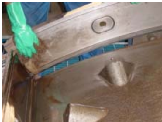
Figura 94. Aplicación de desmoldante a la superficie interna de los moldes (Fuente: Cavalli).
