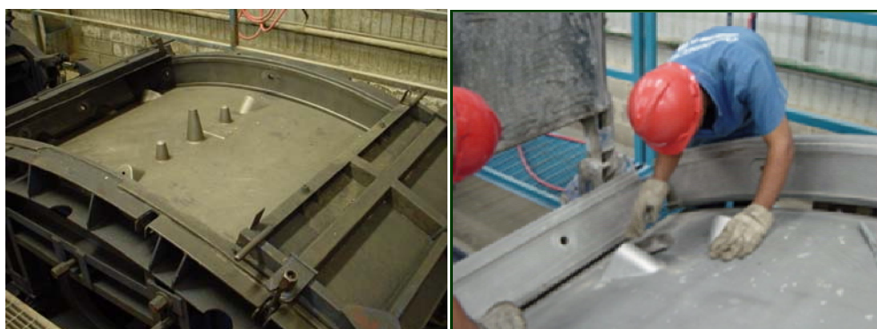
Figura 93. Molde del Segmento E (izquierda) y limpieza del un molde (derecha) (Fuente: Cavalli). Nota: Número de las estaciones modificados por los autores.
