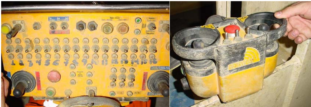
Figura 103. Mando portátil de la Grúa de segmentos. Mando Portátil del Erector con su sistema de vacío, del alimentador de segmentos y de los cilindros de propulsión.
