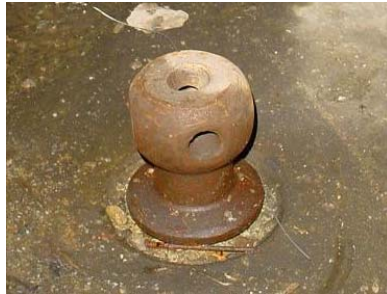
Figura 2. Perno de sujeción del sistema de una tuneladora Lovat.
