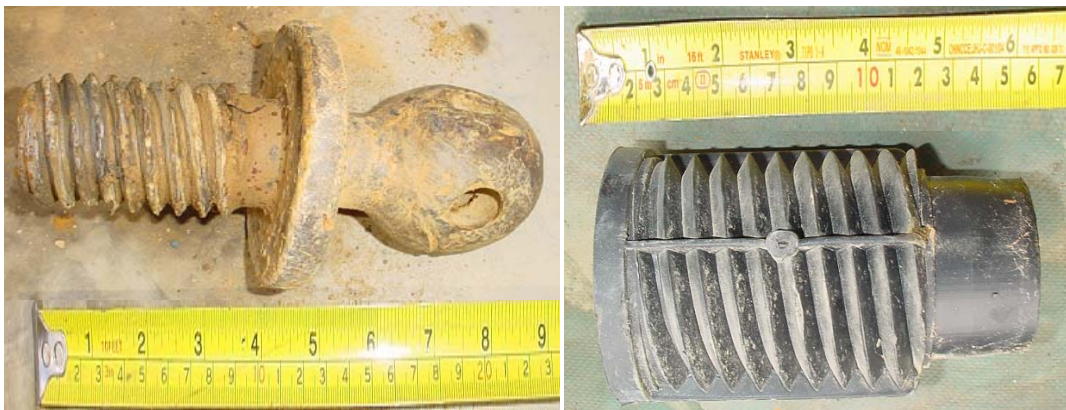
Figura 105. Perno de sujeción de segmentos empleado por las tuneladoras Lovat.
