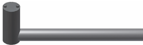
Figura 33. Herramienta de ensamble para las piezas metálicas del Sistema de Sujeción Expandible.
