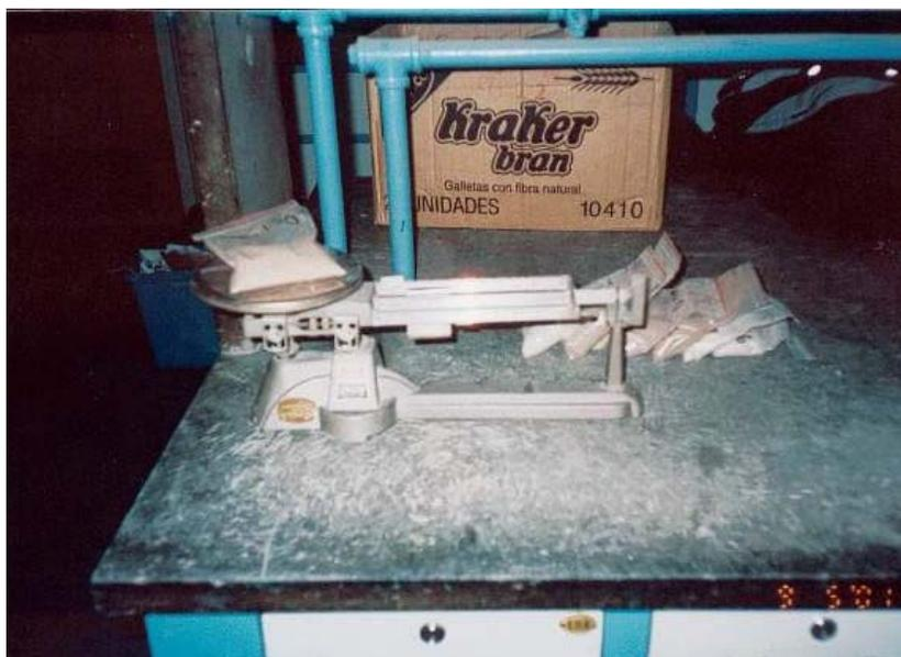
**Figura 4.2.** Pesado de la muestra pulverizada.
