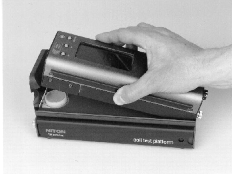
**Figura 4.6.** Colocación correcta del equipo sobre la plataforma de análisis en laboratorio. (Tomado de SACKETT & MARTÍN 1998).
