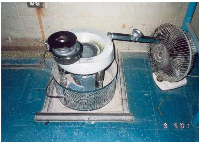
**Figura 4.1.** Equipo de molienda Shatterbox.
