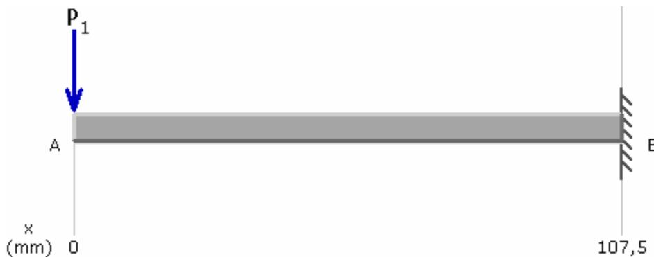
**Figura 4.19.** Modelo para el estudio del tubo roscado.
