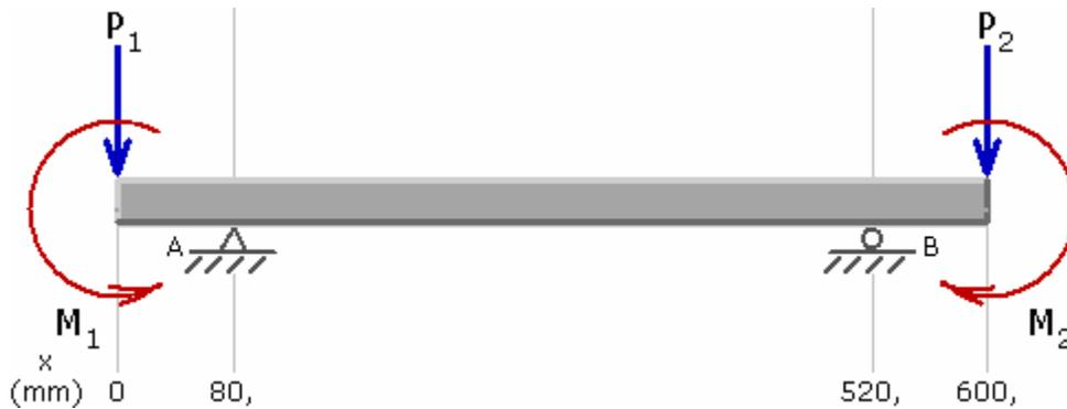
Figura 4.27. Modelo propuesto para el diseño de la base.
