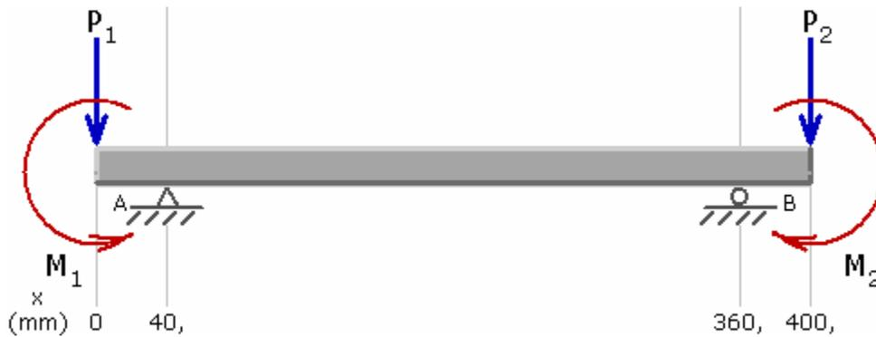
Figura 4.62. Modelo propuesto para el diseño de la base.
