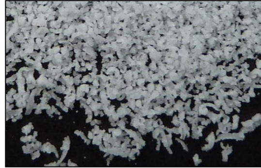
Fig. 12 - Partículas de parafina obtenidas mediante un proceso de rayado manual.
