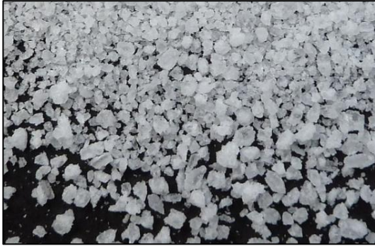
Fig. 11 - Partículas de parafina obtenidas mediante un proceso de cortado manual.
