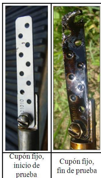
Figura 4.39. Estado del cupón fijo al iniciar y finalizar la prueba de campo
