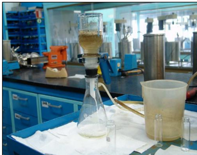
Figura 3.2. Montaje del sistema de filtrado
