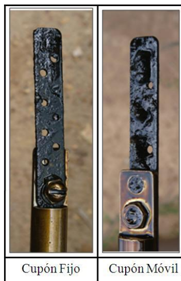
Figura 4.30. Estado de los cupones fijo y móvil empleados durante la evaluación del antiincrustante comercial
