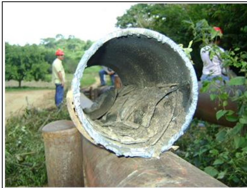
Figura 4.27. Depósitos inorgánicos encontrados en el oleoducto operado por PDVSA Gas, San Tomé
