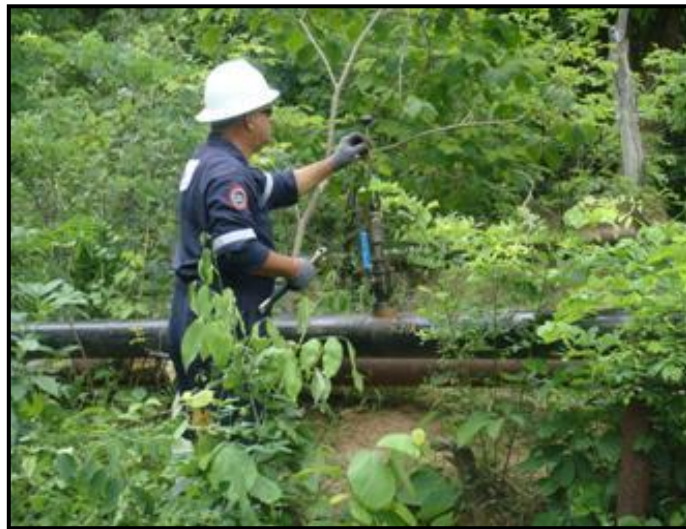
Figura 4.33. Montaje de cupón fijo para prueba con INTAV®
