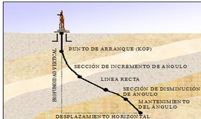
Figura.III.1.11 Pozo tipo “S” especial. [2]
