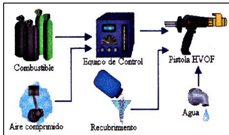
Figura 1.- Esquema de un sistema de rociado térmico por HVOF.
