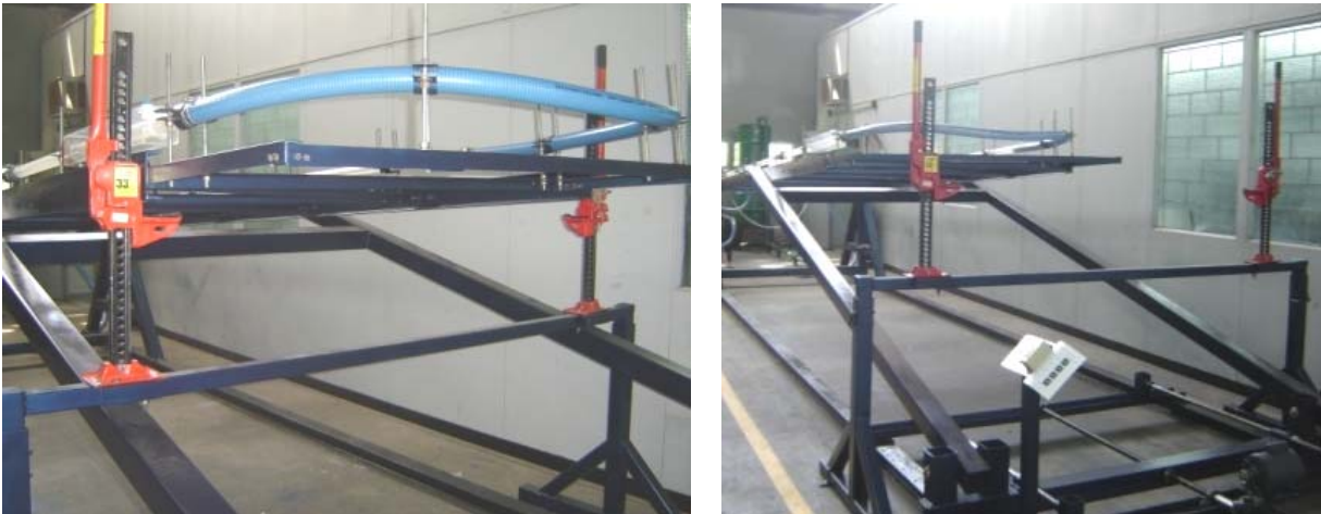
Figura 67. Paso 5. Izq: liberación del apoyo auxiliar. Der: retiro del apoyo auxiliar.
