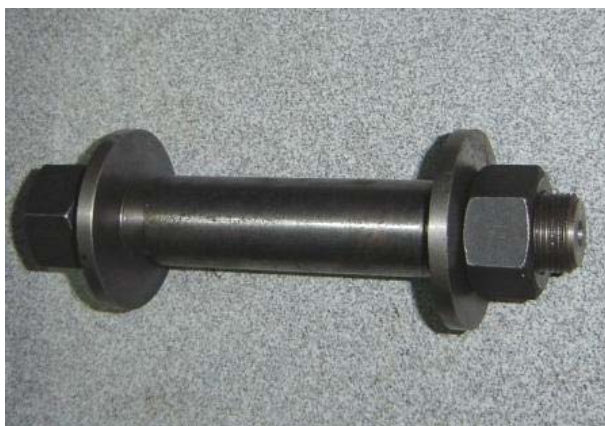
Figura 34. Pernos de unión entre apoyos y largueros
