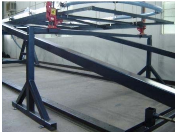
Figura 39. Apoyo auxiliar luego de su construcción
