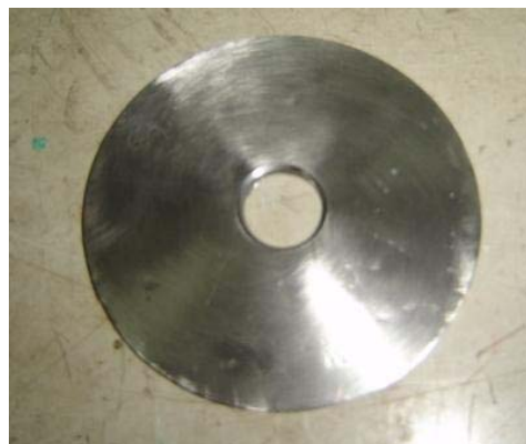
Figura 56. Características de la placa orificio
