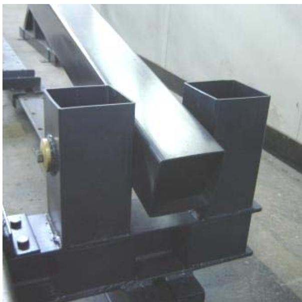
Figura 31. Soportes de vástagos “B” sobre carro “B” luego de su construcción
