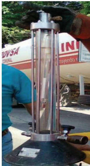
Fig. D.4. Toma de muestras para medir para medir la gravedad específica del GLP
