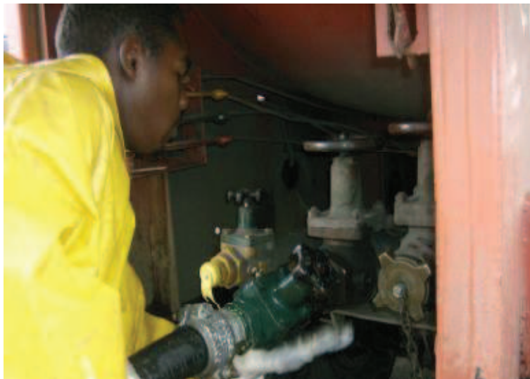
Fig.D.2. Conexión de mangueras a cisterna (tomado de manual de PDV Comunal)
