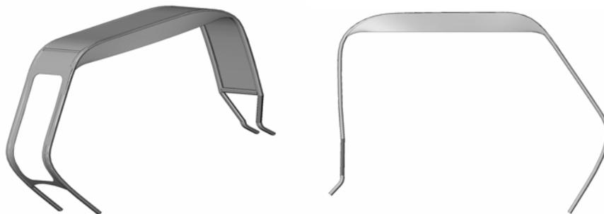
***Características:*** De secciones tubulares paralelas, este diseño se caracteriza por ser un tanto “recto”, ya que solo se aprecian dobleces en cuatro zonas específicas y una parte posterior “achatada”. Posee un parabrisas que separa el aire de la parte frontal del chofer. Está sostenido de los extremos de ambas
