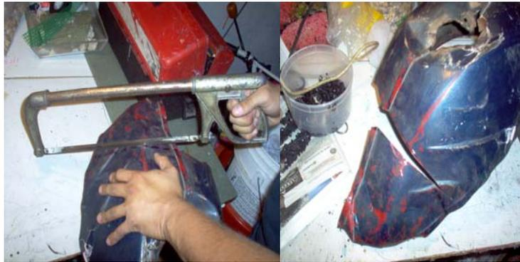
*Figura 4.4. Demarcación y seccionamiento del guardafango*
