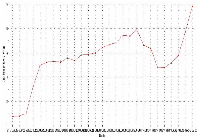
Gráfica 4.11. Esfuerzo von Misses vs. nodo pata izquierda trasera.
