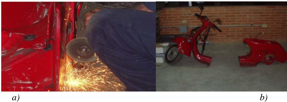
Figura 5.7. a) Corte con esmeril de mano, b) Corte de la moto.
