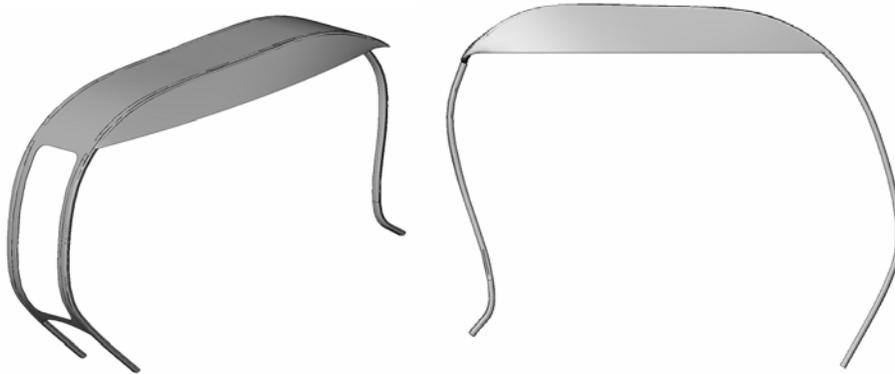
Características: De secciones tubulares paralelas sustenta un parabrisas y una reducción posterior que continúa en un solo tubo apoyado en la parte trasera de la motocicleta. De líneas suaves protege de un día solado y lluvia tan solo en la parte frontal y superior. Resguardo elaborado de lámina de aluminio.
