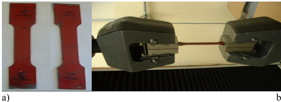
*Figura 4.8. a) Probetas elaboradas, b) máquina de ensayo de tracción.*
