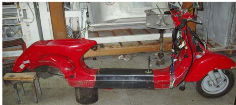
Figura 5.9. Corte y ensamble de la nueva sección.
