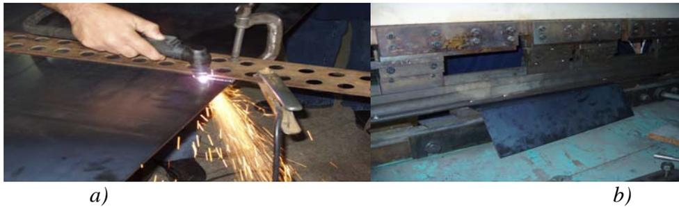
Figura 5.8. a) Corte con plasma de la lámina, b) Doblez en plegadora de cortina
