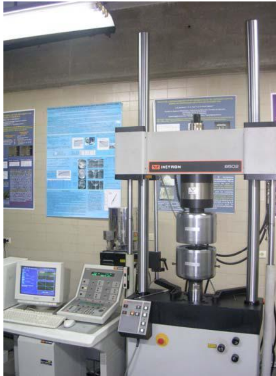
Figura 1.3 Máquina universal de ensayos mecánicos Instron 8502, ubicada en el Laboratorio Nacional de Referencia para la Evaluación de Propiedades Mecánicas, Desgaste y Corrosión de Materiales, Escuela de Ingeniería Metalúrgica y Ciencia de los Materiales, Facultad de Ingeniería, Universidad Central de Venezuela.
