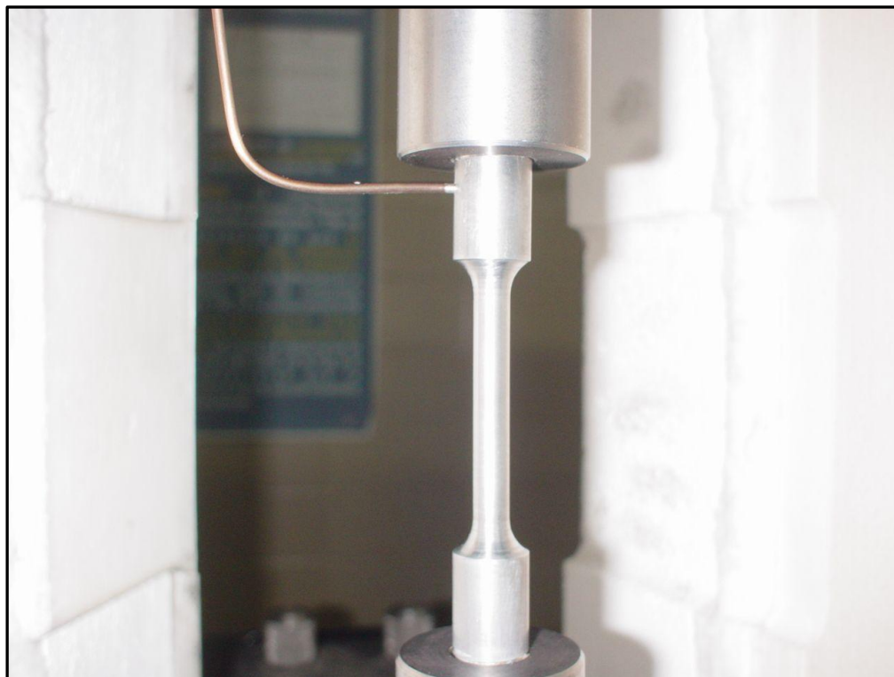
Anexo 18 Termocupla insertada dentro de la probeta
