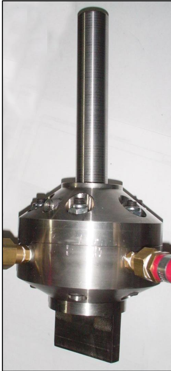
Anexo 16 Base y eje del extensor ensamblados
