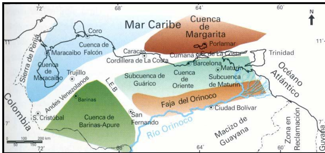
Figura 3.2 Cuencas Petrolíferas de Venezuela según la distribución de sus Provincias Sedimentarias. L.E.B. Lineamiento de El Baúl, límite entre las cuencas de Oriente y Barinas-Apure.
