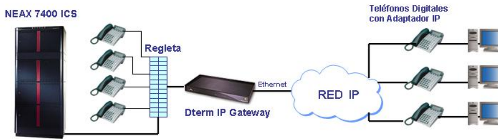
Figura 11.- Implementación de extensiones IP utilizando un Dterm IP Gateway y teléfonos digitales a IP usando adaptador IP (Dterm IP Adapter).
