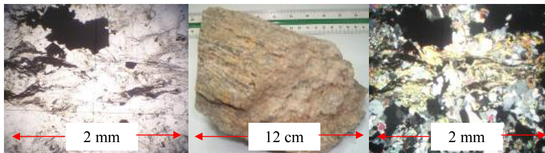
Figura 26. Muestra de mano (centro), fotomicrografía en nicols paralelos (derecha) y cruzados (izquierda), objetivo 4/0.12 ocular 12.5X
