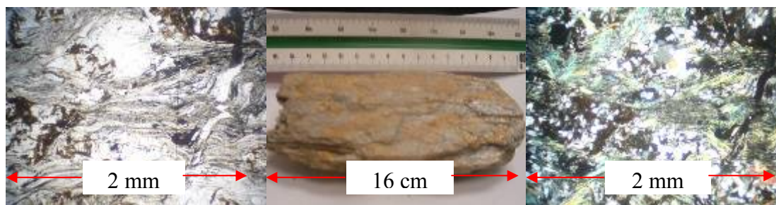
Figura 20. Muestra de mano (centro), fotomicrografía en nìcoles paralelos (derecha) y cruzados (izquierda), objetivo 4/0.12 ocular 12.5X
