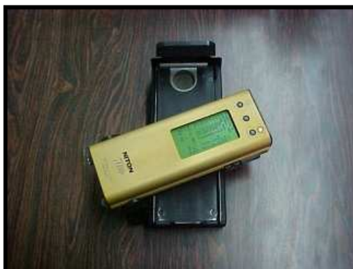
Figura 2.7 Espectrómetro Niton XL-722S, serie 700. Tomado de CEDILLO & OLAYA (2003).
