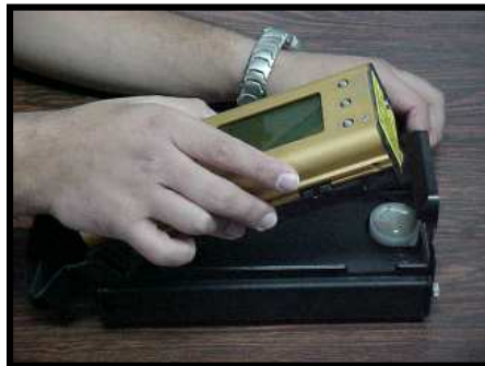
Figura 2.8 Montaje del equipo sobre la muestra en su plataforma de análisis. Tomado y Modificado de CEDILLO Y OLAYA (2003).
