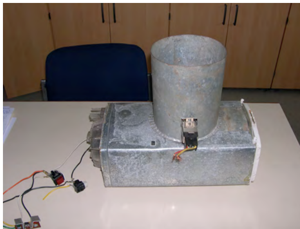
Figura 26. Aparato construido para inyectar aire caliente. El aire se calienta con una resistencia eléctrica
