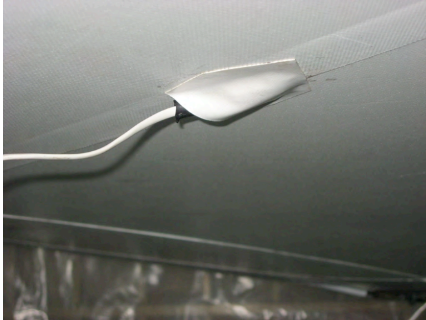
Figura 30. Sensor integrado colocado en bolsillo bajo la membrana Fuente: Elaboración propia.
