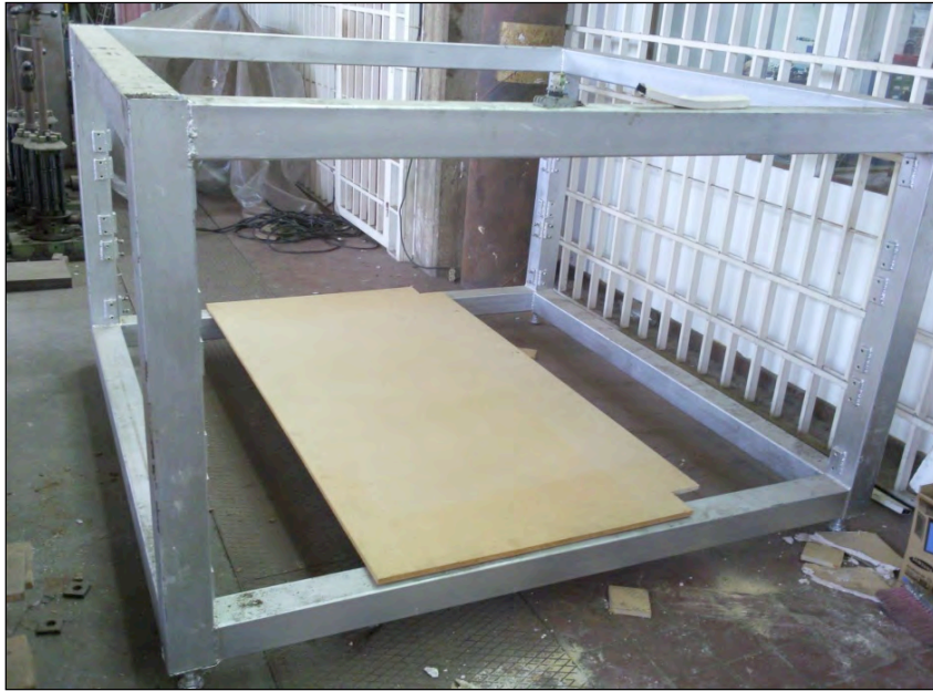
Figura 13. Estructura del Banco de Ensayos con base fija de contraenchapado recubierta de lámina galvanizada Fuente: Elaboración propia.
