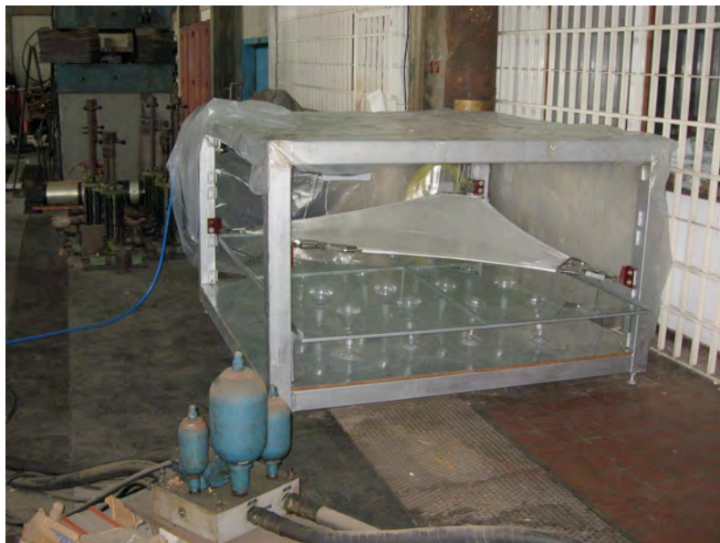
Figura 29. Ubicación de las 16 lámparas infrarrojas bajo la membrana Fuente: Elaboración propia.
