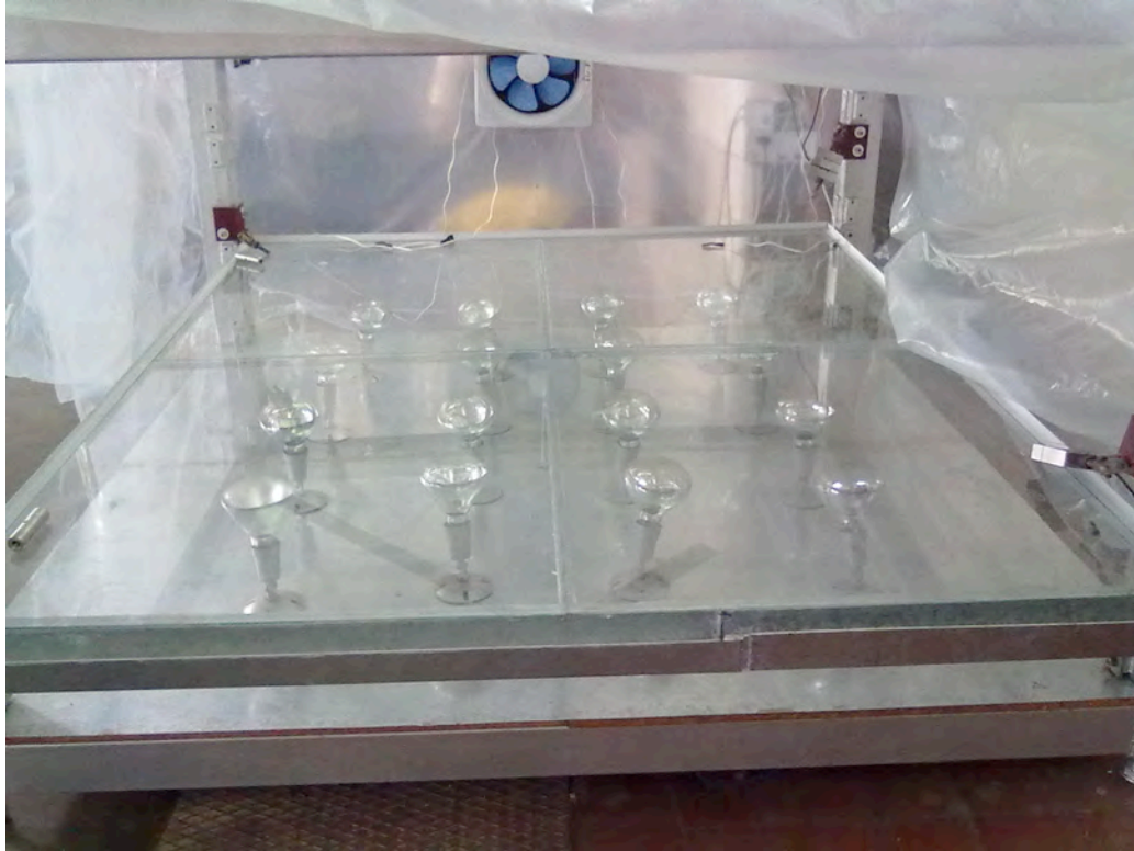
Figura 33. Láminas de vidrio que protegen las lámparas del agua en los Ensayos de Humedad
