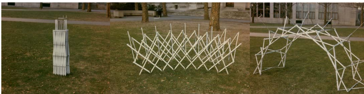
Fig.21 Modelo de malla transformable , sistema de tijera.
