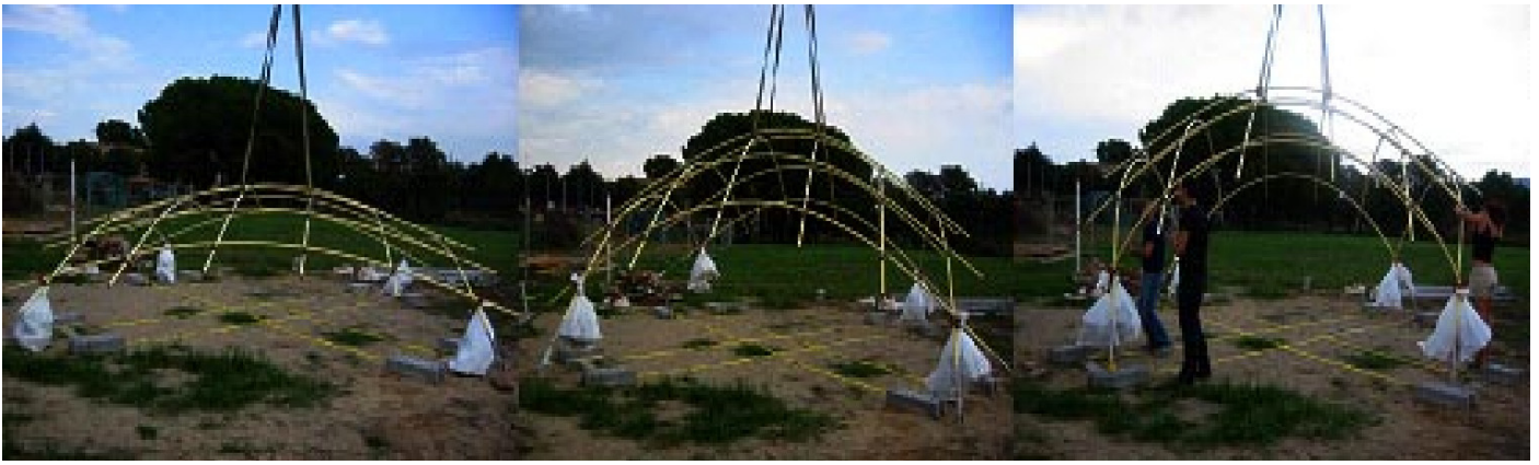
Fig.28 Proceso de deformación modelo de malla preflexada.
