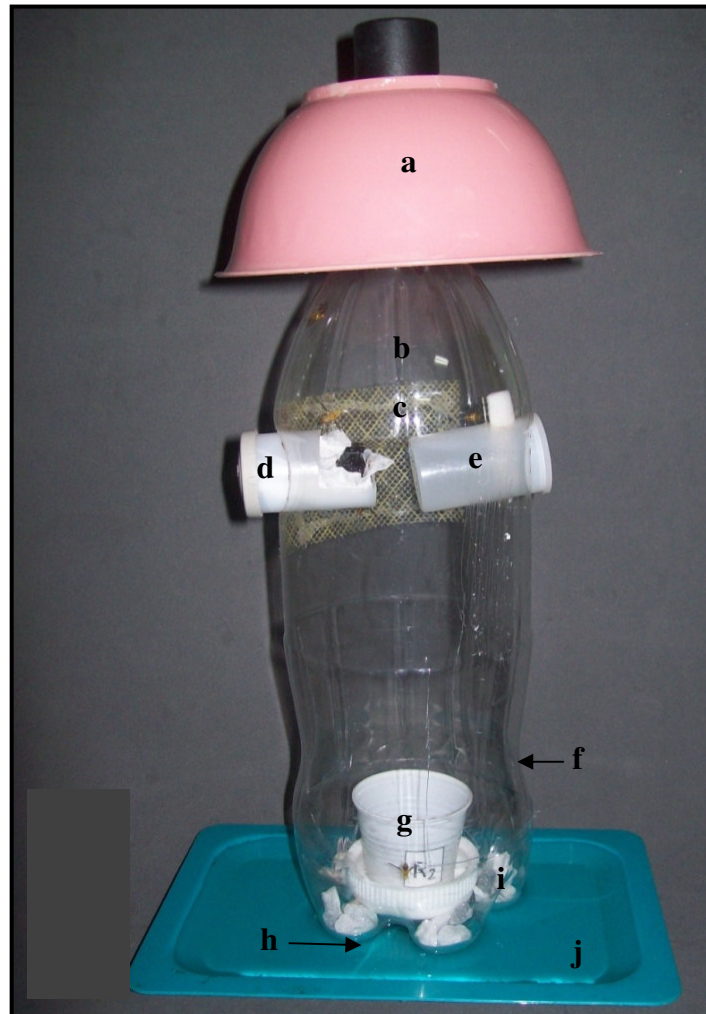
Figura 5. Jaula para bioensayos. Material básico de construcción: botella plástica de refresco de 2L. Componentes: a) protector de iluminación. b) cuerpo cilíndrico transparente. c) área de ventilación a través de malla ( 24/\text{cm}^2 ). d) dispensador para dieta carboproteica. e) dispensador de agua con mecha de algodón. f) abertura rectangular ( 8 \times 6 cm) para manipulación de insecto g) contenedores de plástico ( 73 \text{ cm}^3 ). h) poro para drenaje de agua. i) piso de grava. j) bandeja colectora de agua.
