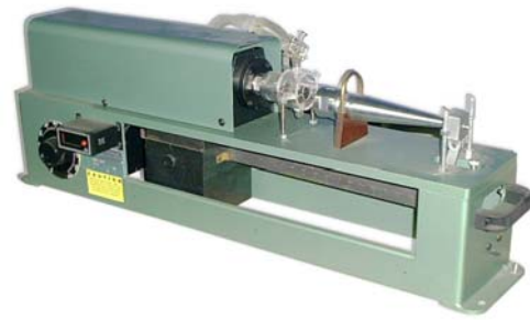
Fig. 23 Máquina de Flexión Rotativa con cámara de Corrosión
