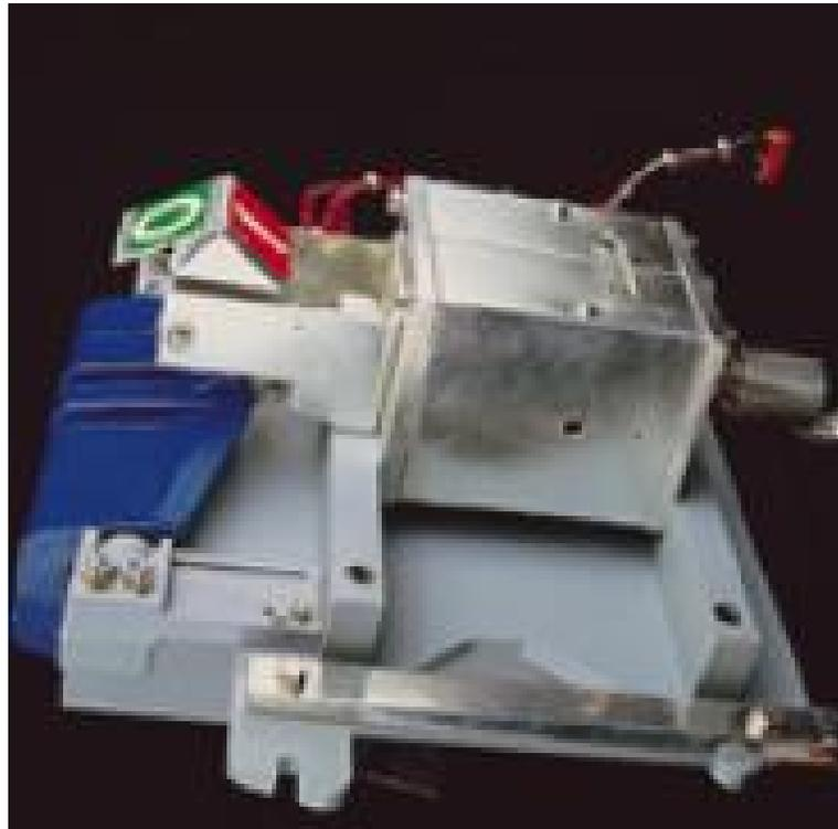
*Figura. N°II.5. Actuador Magnético.[1]*
