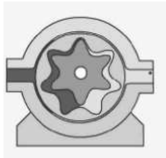
Figura i: Bomba de rotor simple conocida en la industria como Gerotor.
