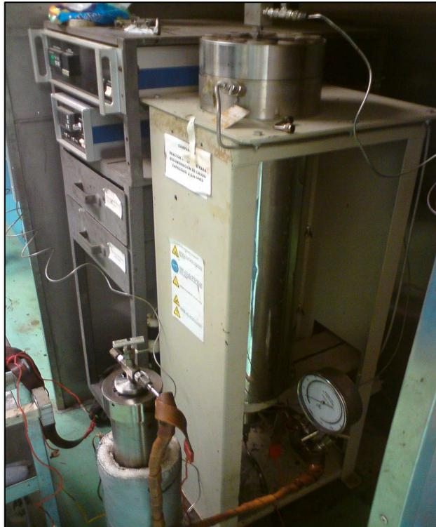
Figura IV.6 Reactor utilizado para la recombinación del crudo (Teixeira, 2010)
