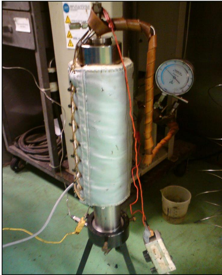
Figura IV.7 Equipo utilizado para la inyección de crudo hacia el reactor (Teixeira, 2010)
