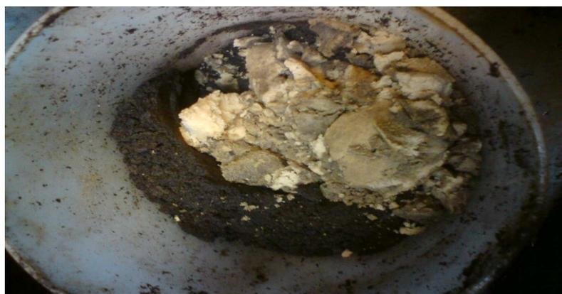
Condición final de la arena donde se observa la canalización de los fluidos
